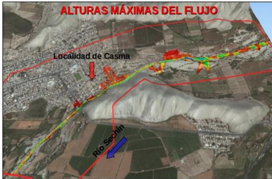
Figura 48: Vista tridimensional de las alturas máximas del flujo para el umbral de inundación
