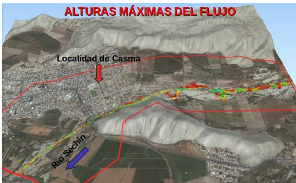
Figura 50: Vista tridimensional de alturas máximas del flujo para un evento hidrometeorológico con un caudal de 10 \text{ m}^3/\text{s}
