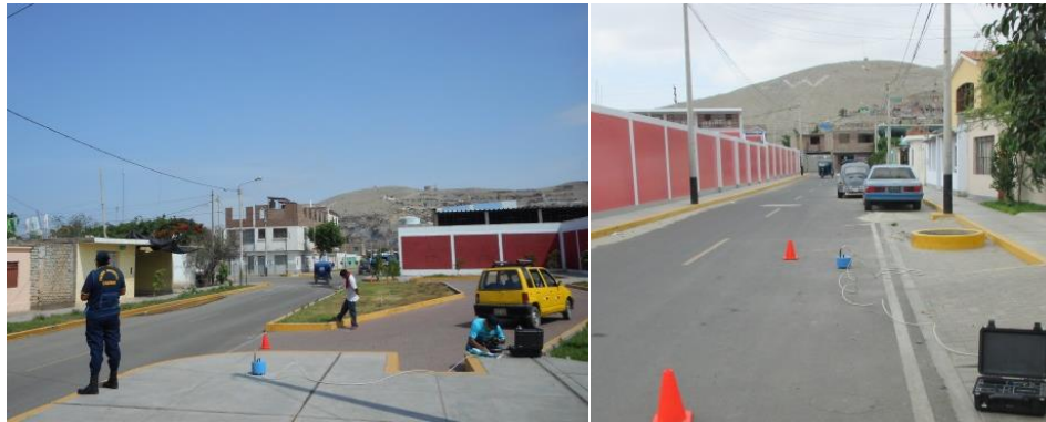
Figura 7: Equipo sísmico utilizado para el registro de vibraciones ambientales en la ciudad de Casma: sensores Lennartz (2N) y registrador CityShark
