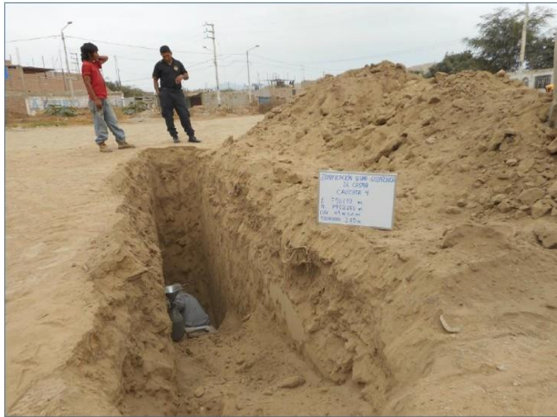
Figura 5: Calicata elaborada en la ciudad de Casma con el apoyo de la municipalidad. Extracción de muestras para conocer, por ejemplo, la densidad del suelo mediante el método del cono de arena.
