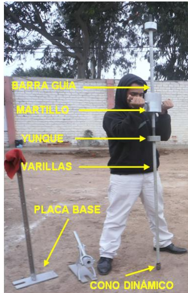
Figura 6: Equipos, accesorios y técnica de DPL
