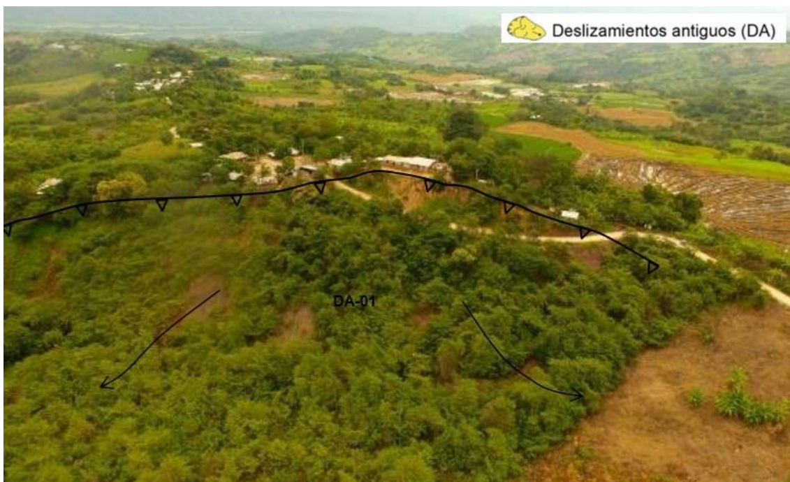
Figura 09. Deslizamiento antiguo próximo a la zona urbana del centro poblado Vista Alegre, vista de este a oeste.
