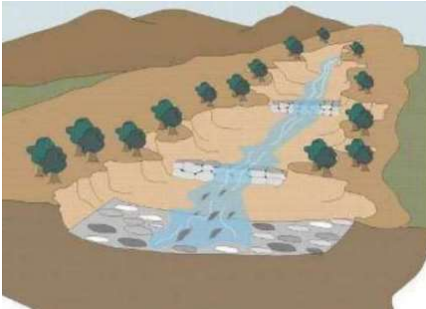
Figura 30. Presas de sedimentación escalonada para controlar la fuerza destructiva de los huaicos (INGEMMET, 2003).
