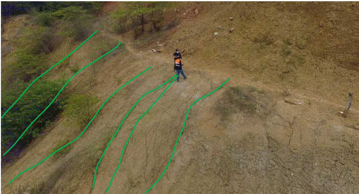
Figuras 16. Cárcavas de 10 cm de ancho y 3 m de largo en el cuerpo del deslizamiento.
