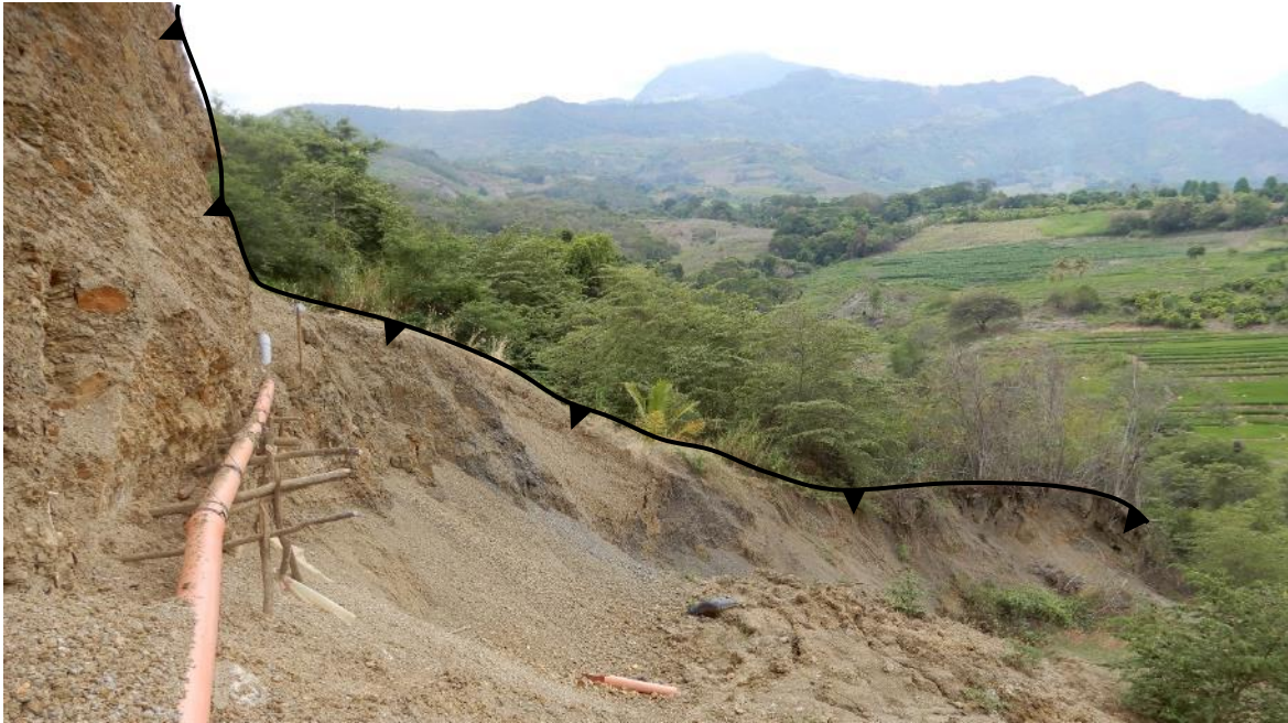
Figura 15. Escarpe de deslizamiento, acequia entubada para evitar la infiltración de agua.
