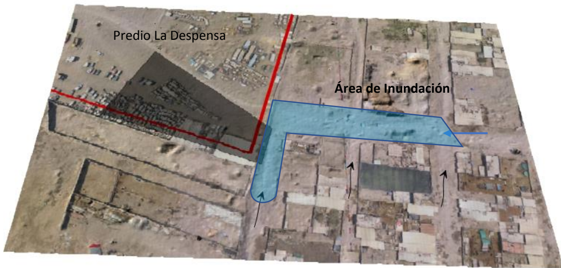
Figura 25. Mapa de inundación pluvial y depresiones topográficas identificadas en el área de estudio.
