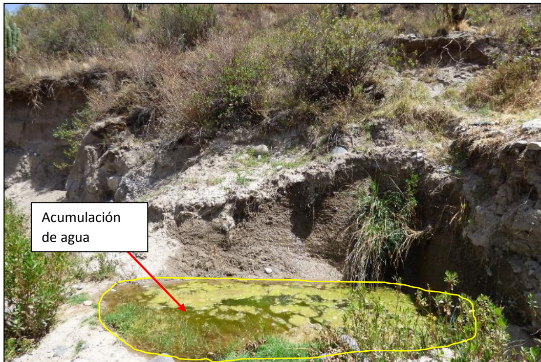
Figura 28. Surgencias de agua en el sector de Urinsaya; en la parte alta del pozo séptico de Ichupampa, (coordenadas UTM E: 211396, N: 8267854).
