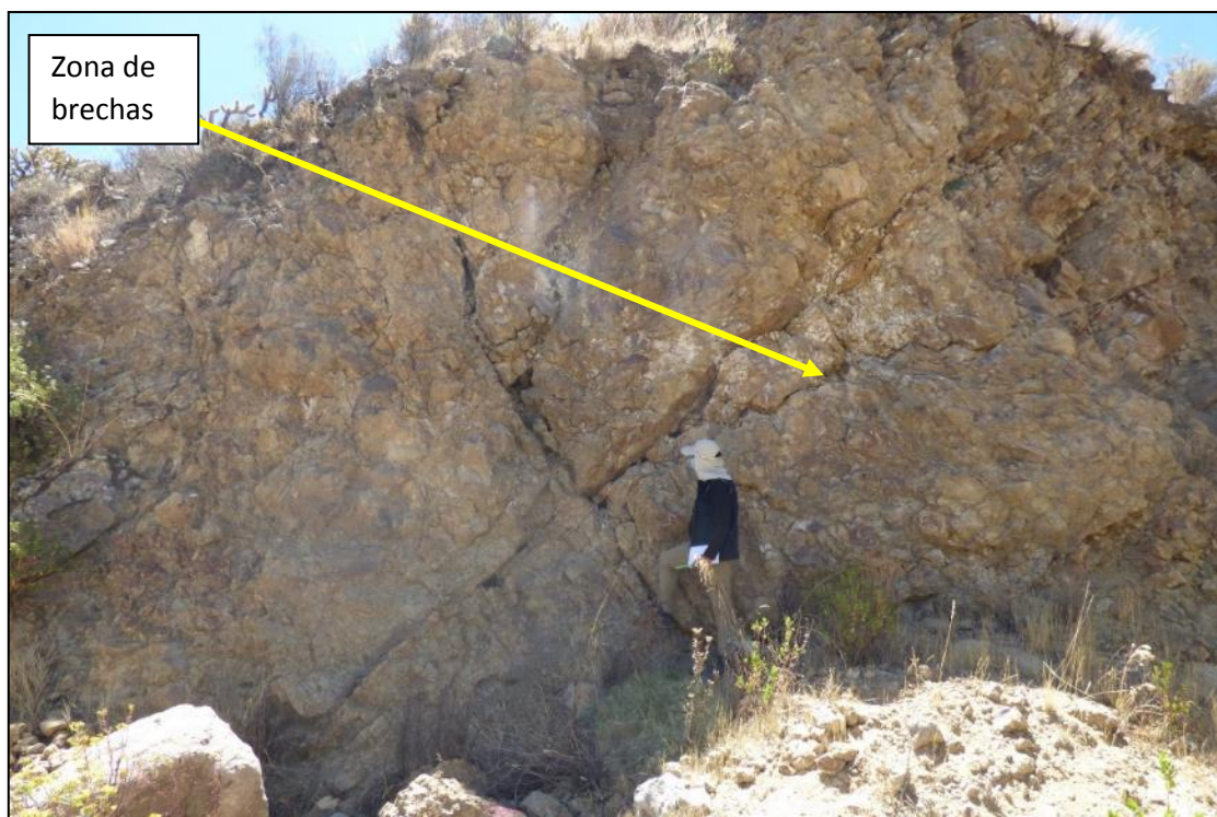
Figura 4. Zona de brechas donde se visualiza aparentemente una falla de dirección NO-SE, (coordenadas UTM E: 211636, N: 8264013).
