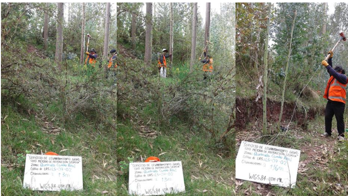
Fotografías: Vista de la ejecución del ensayo de refracción sísmica - golpe (shot) entre los geófonos a + 3m, + 5m y a + 16m de la LS-07-02
