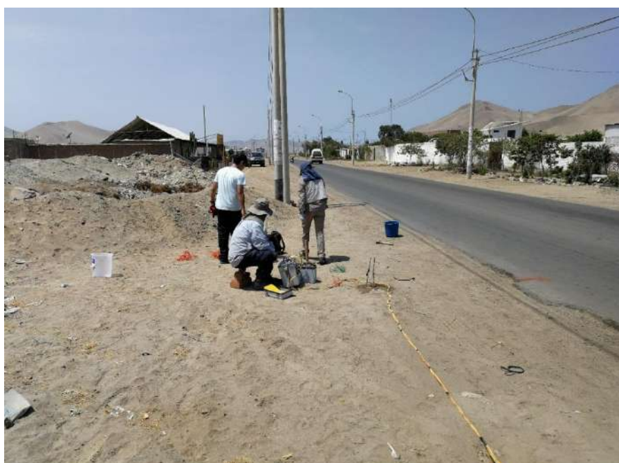
Fotografía 4.8 Muestra el alineamiento de la línea LT-8 de forma paralela a la línea de costa, se realizó un perfil de una longitud de 230 metros.
