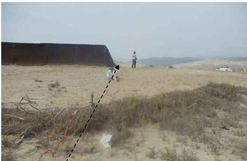
Fotografía 4.6: Muestra el alineamiento de la línea LT-6 de forma transversal a la línea de costa, se realizó un perfil de una longitud de 230 metros.
