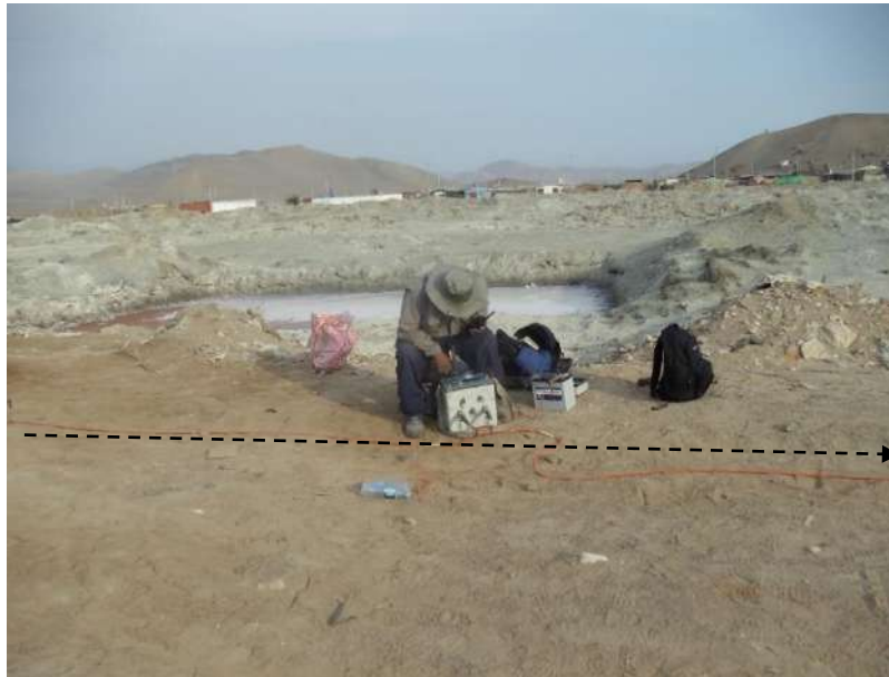
Fotografía 4.2: Muestra el alineamiento de la línea LT-2 perpendicular a la línea LT-1. Se realizó un perfil de una longitud de 230 metros.
