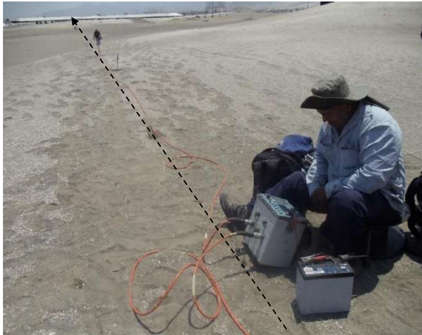
Fotografía 4.7: Muestra el alineamiento de la línea LT-7 de forma paralela a la línea de costa, se realizó un perfil de una longitud de 230 metros.
