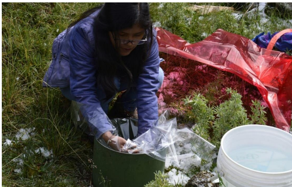
Fotografía 7. Ensayo de infiltración en época húmeda en la parcela clausurada.
