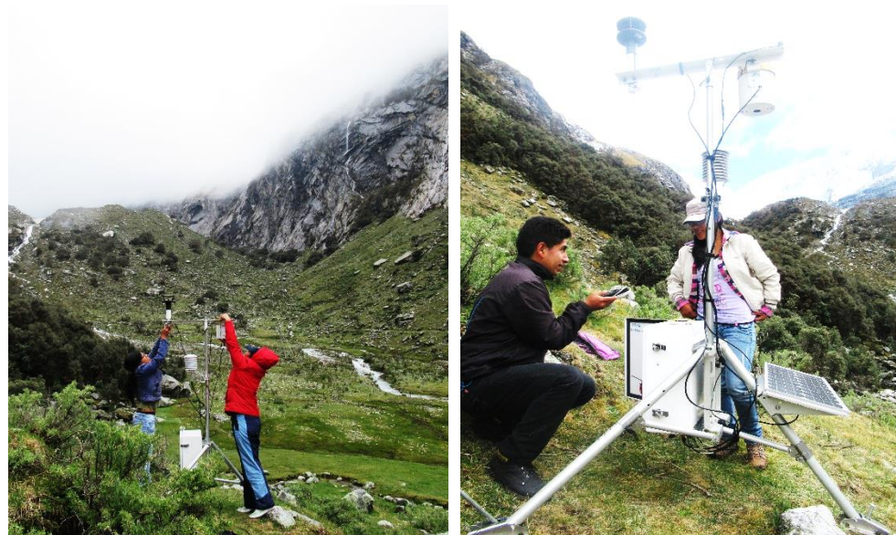
Figura 10: Instalación, registro de datos y recolección de datos en la estación meteorológica portátil.
