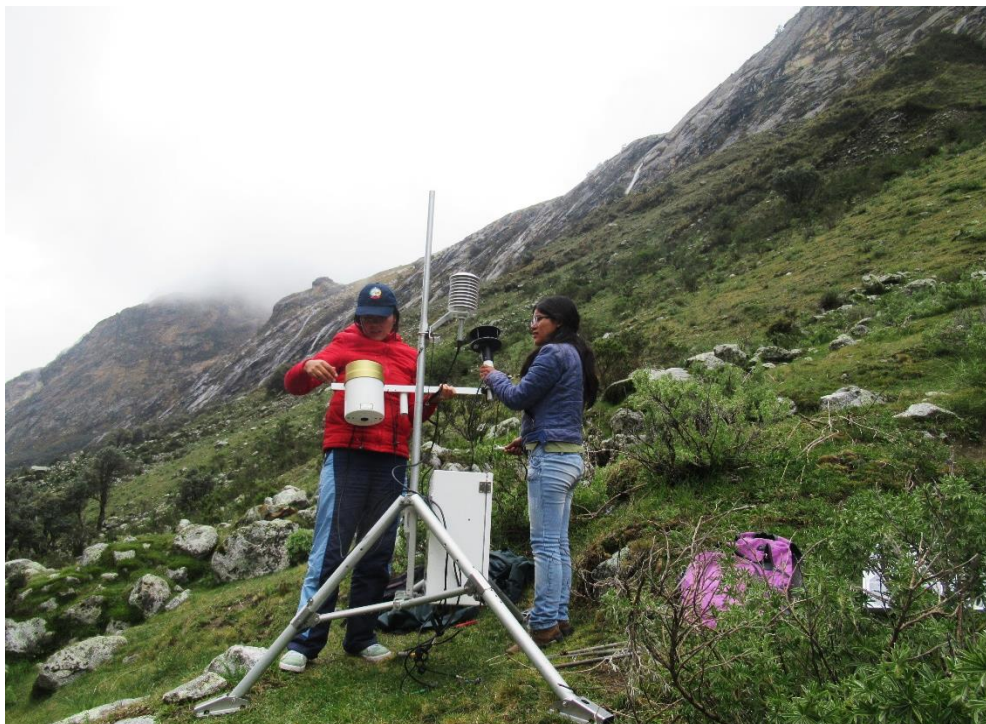
Fotografía 6. Instalación de Estación meteorológica portátil.
