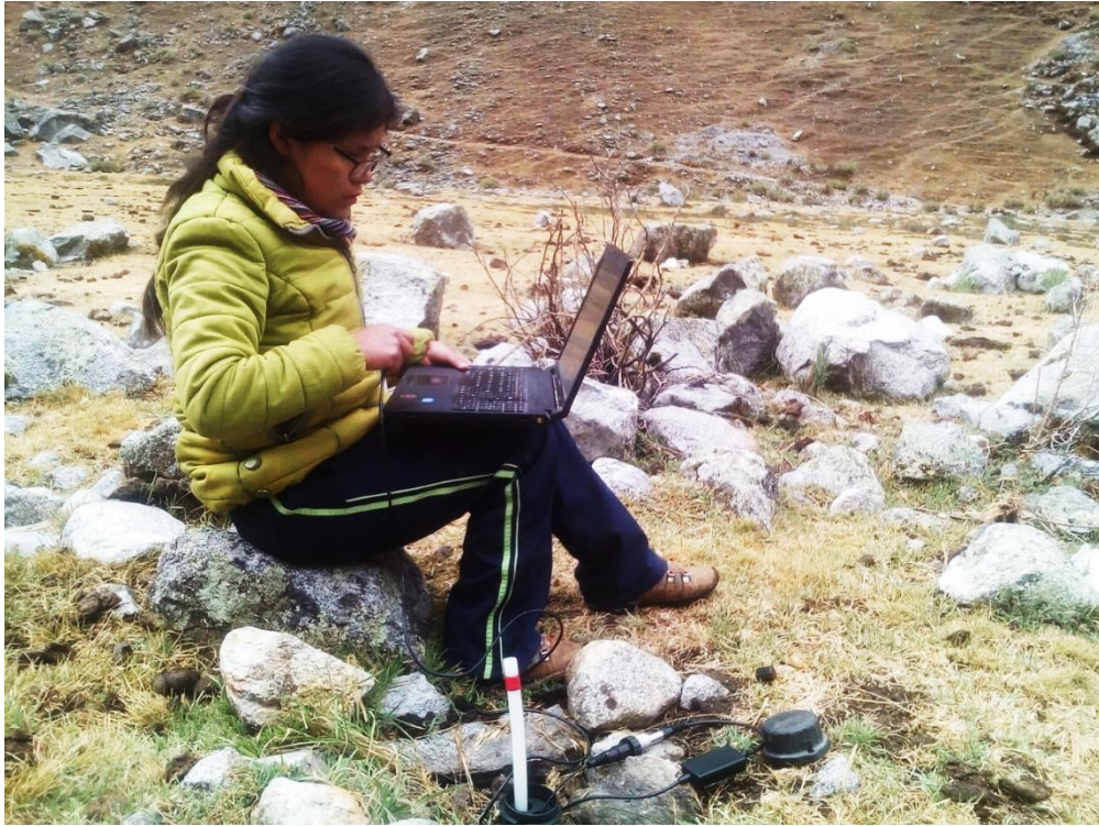
Fotografía 9. Descarga de datos de piezómetro ubicado en la parcela testigo.
