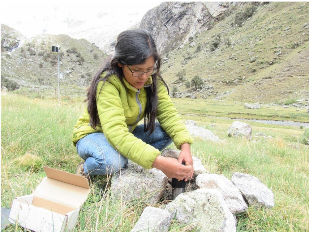
Fotografía 10. Sacando el seguro para descargar datos de piezómetro ubicado en la parcela clausurada.
