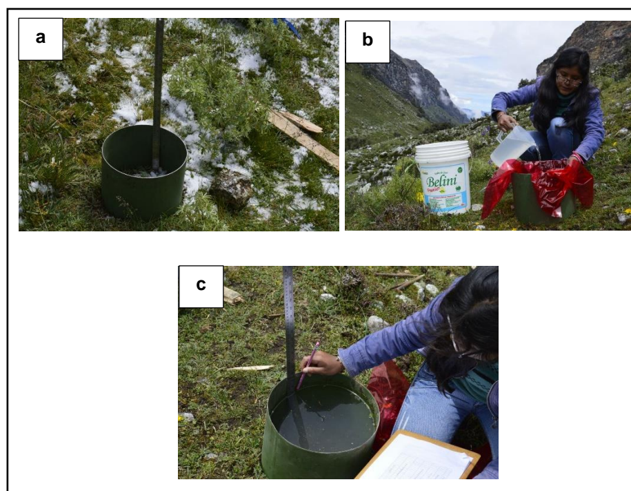
Figura 12: Procedimiento de ensayo de infiltración con cilindro.
