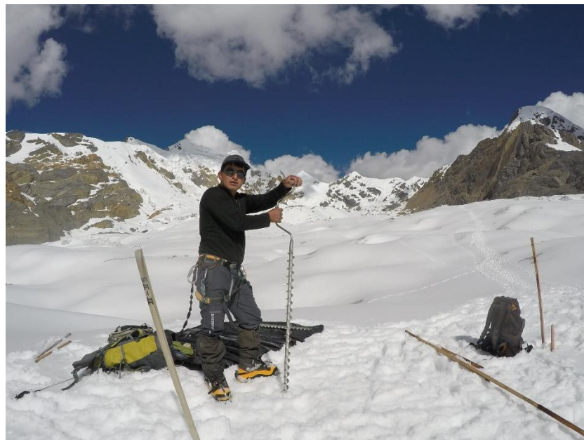
Fotografía N° 2: Personal técnico realizando perforación en la zona de ablación.
