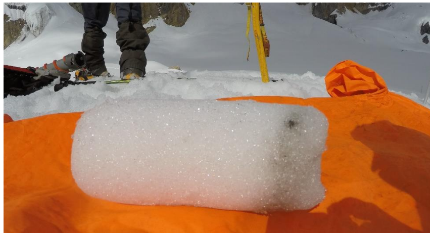
Fotografía N° 1: Actividades de extracción de la muestra de nieve para determinar la densidad en e
