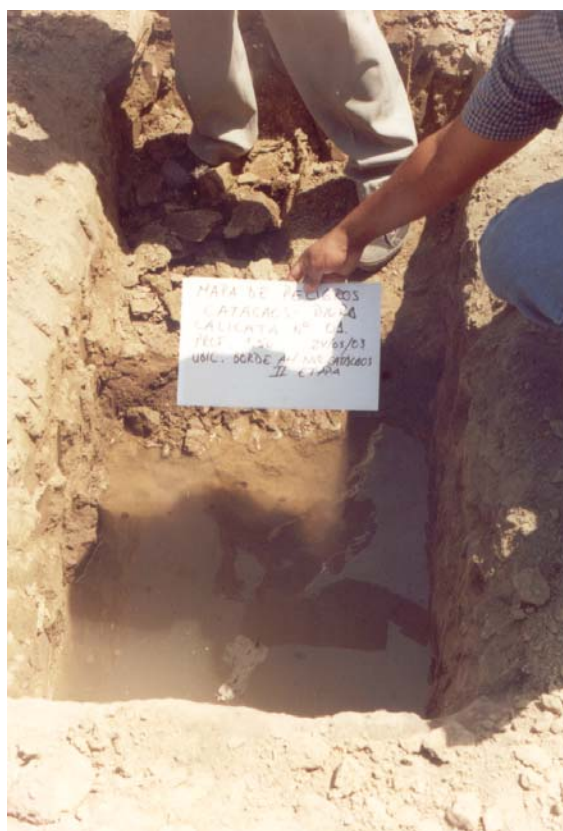
Calicata con presencia de la Napa Freática A.H. Nuevo Catacaos II etapa
