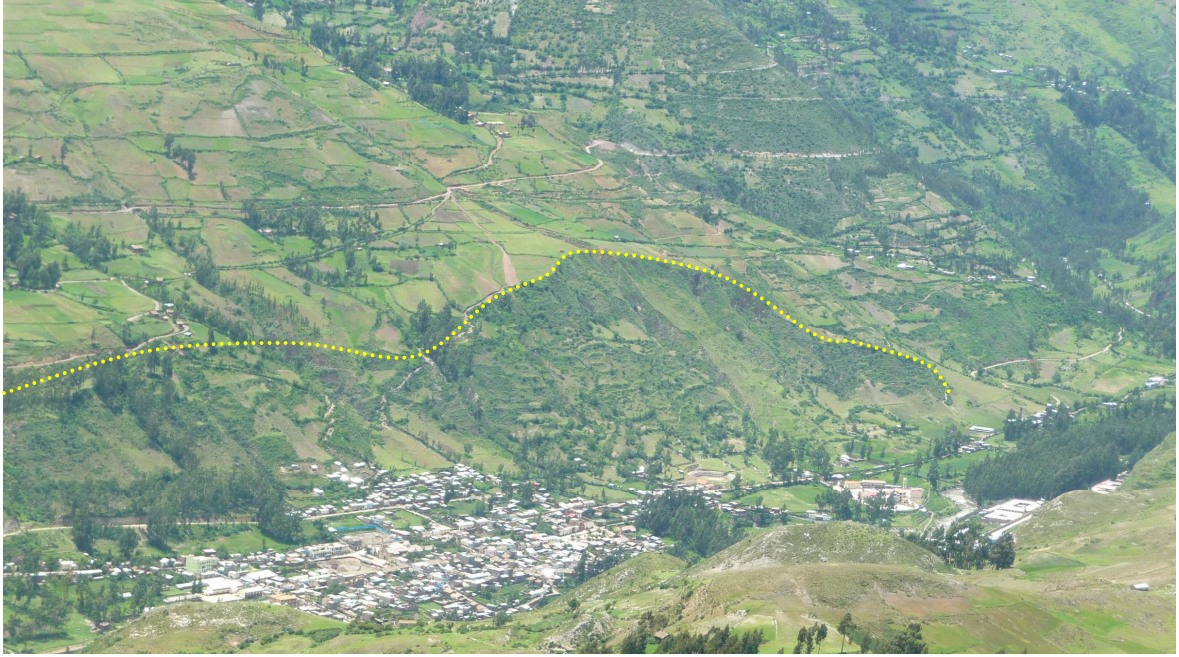
Foto N° 3. Escarpa principal del posible deslizamiento ubicado en el flanco Oeste del cerro Latapuquio, al pie de la ladera se observa el Barrio Pueblo Nuevo.
