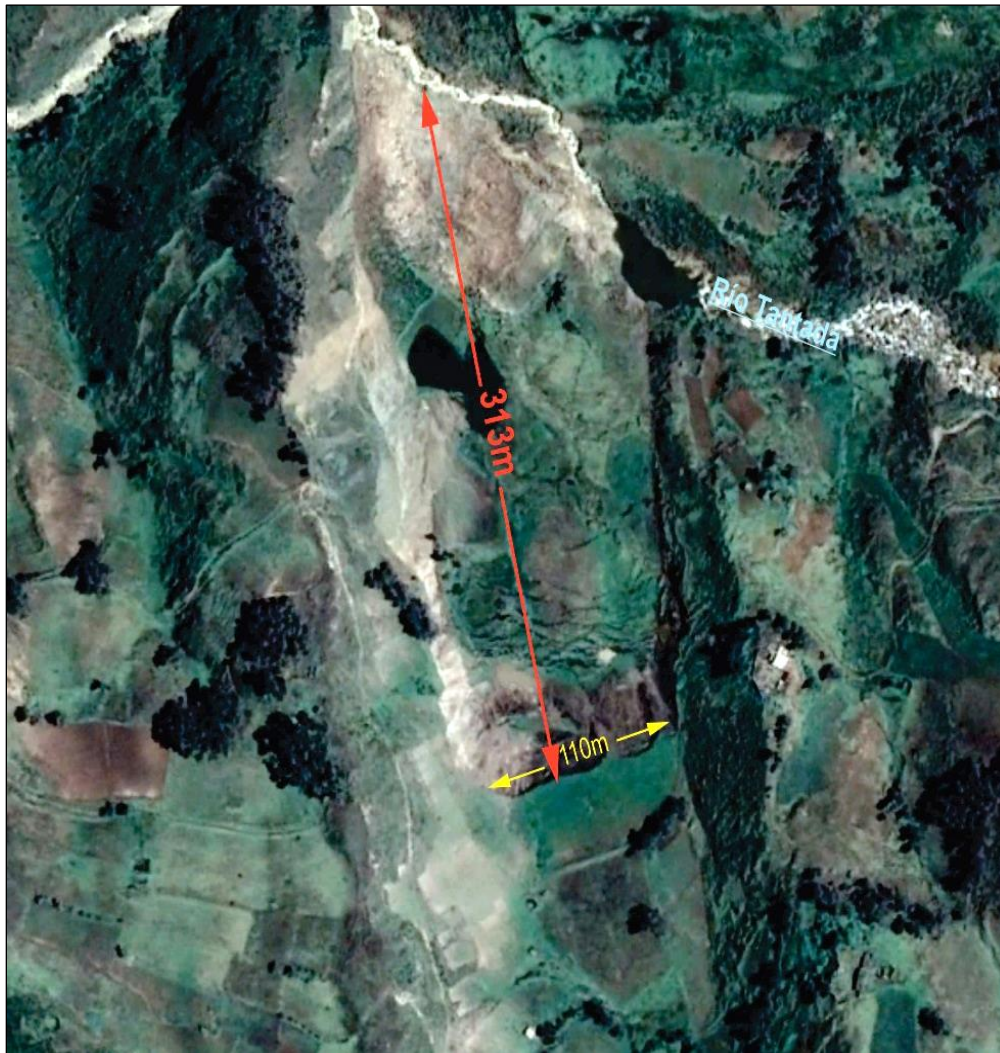
Figura 17. Vista del deslizamiento de Huagal, se observa agrietamientos transversales (Imagen satelital del año 2019).
