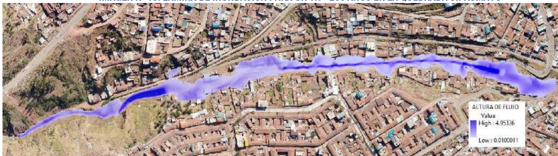
IMAGEN N° 13: LAMINA DE INUNDACIÓN PARA UN TR=200 AÑOS EN LA QUEBRADA SIPASMAYO
