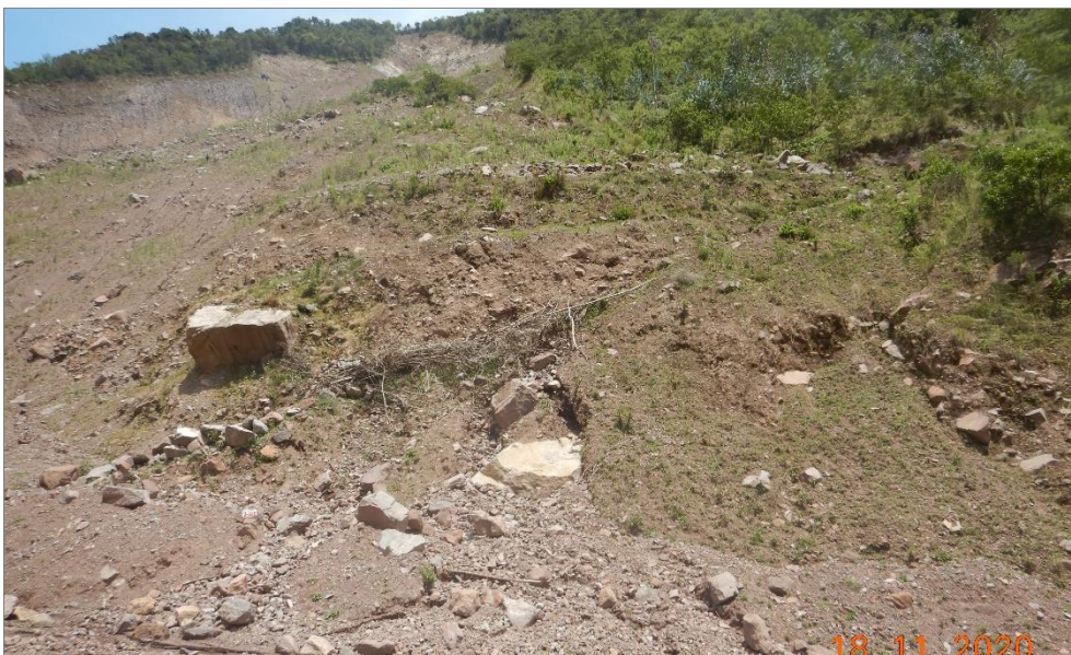
Fotografía 2. Depósito de deslizamiento, conformado por gravas y bloques de formas angulosas, inmersos en matriz areno - arcilloso.
