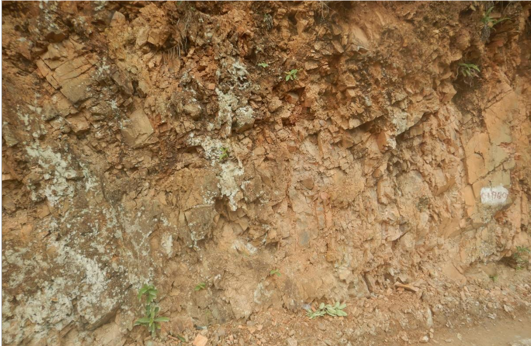
Fotografía 1. Cuarcitas medianamente fracturadas y moderada a altamente meteorizadas de la Formación San José. Con coordenadas UTM (WGS 84): 765178 E, 8585270 S a 1618 m s. n. m.
