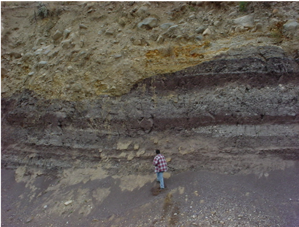
Foto 05.- Intercalaciones de secuencias granodecipientes de 0.50 a 1 metro de espesor. Varían de Conglomerados en la base a niveles lutíticos en el tope. Estos niveles lutíticos, por efecto de las lluvias se meteorizan con facilidad.
