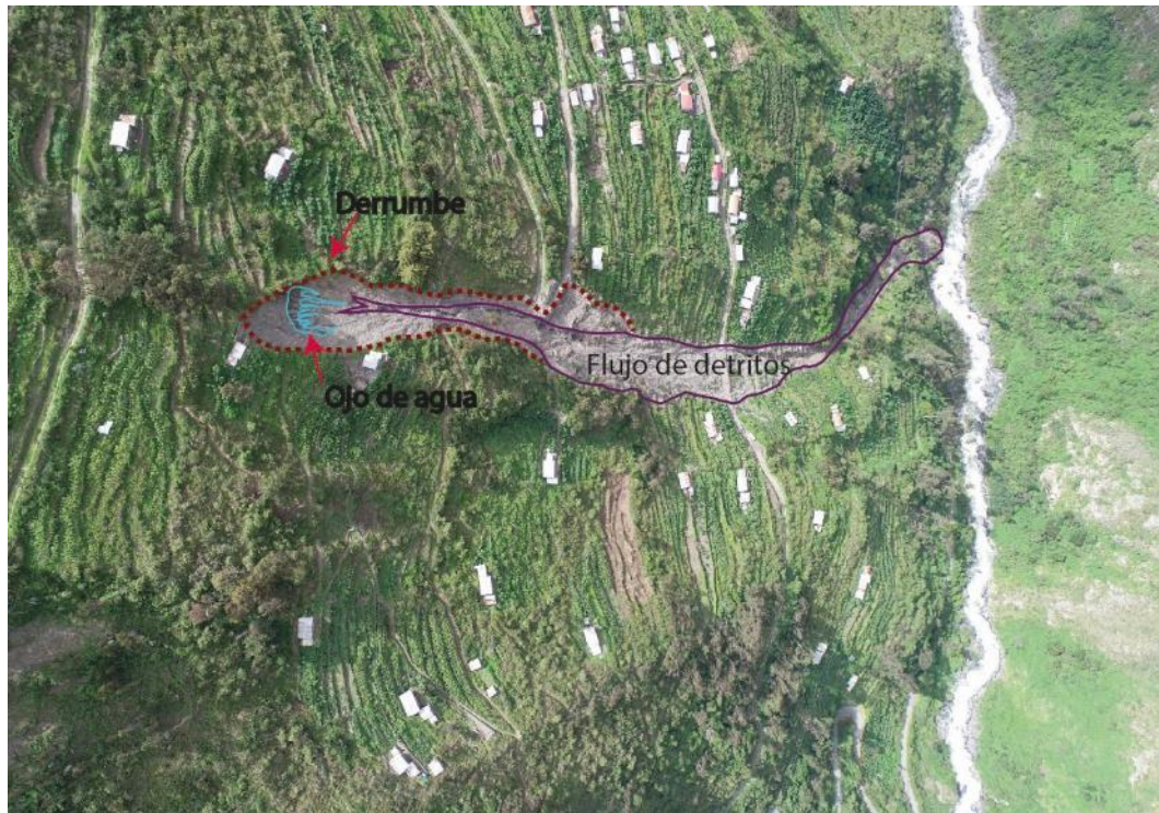
Figura 16. Imagen tomada con dron, se observa delimitado el escarpe de derrumbe, el flujo de detritos que discurre hasta el río Sandía, se muestra también afloramiento de agua en el escarpe del derrumbe, ubicado en el sector Llamani.
