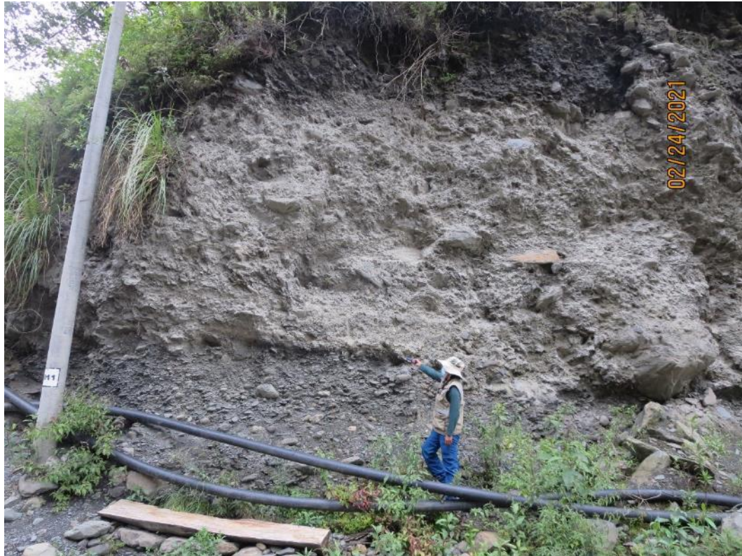
Fotografía 8. Con coordenadas UTM (WGS 84): 449597, 8415642 S se observa depósito coluvial que sobreyace al depósito aluvial con clastos redondeados a subredondeados inmersos en una matriz arenolimoso.
