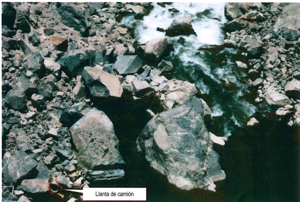
Foto 14. Se observa el tamaño de bloques del depósito de derrumbe y como escala se tiene la llanta de camión. Vista aguas abajo.
