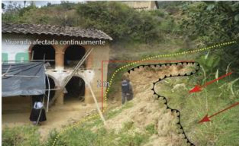
Figura 27. Cuerpo del deslizamiento y la altura del escarpe del material con vivienda afectada continuamente (Coordenadas UTM (WGS 84): 387645 E, 8910599 S, a 2708 m s.n.m.)
