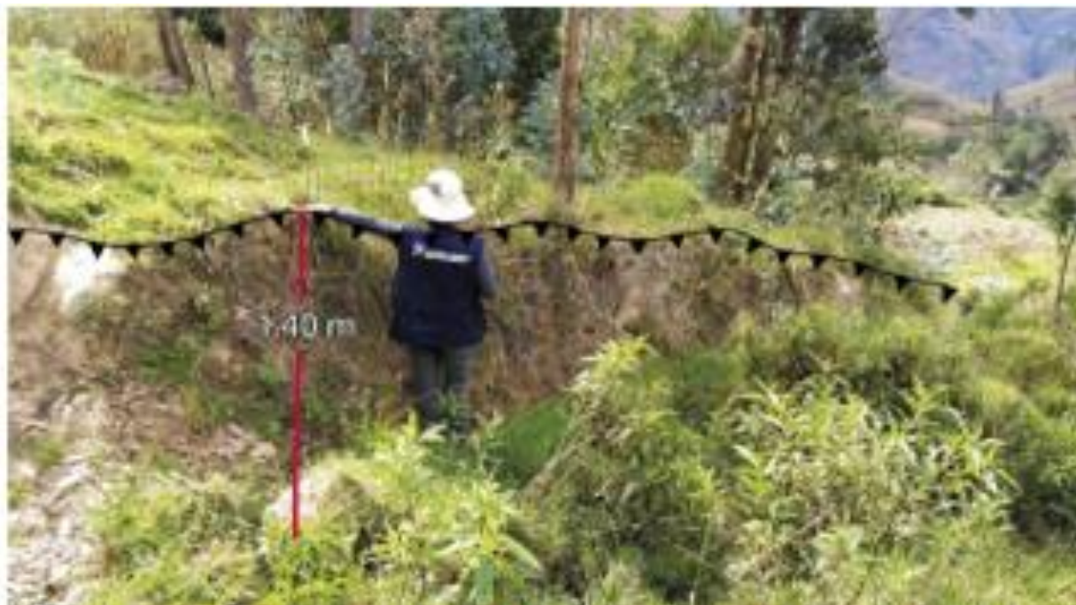
Figura 26. Muestra el escarpe lateral izquierdo del deslizamiento Cochapampa de 1.4 m.
