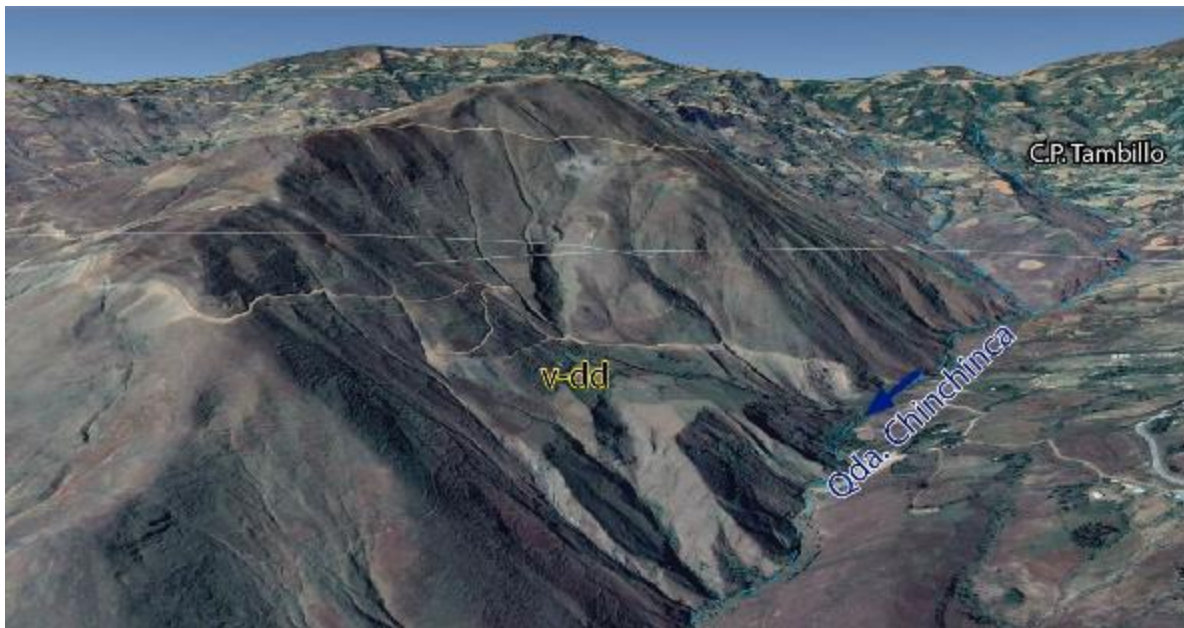
Figura 15. Se observa una vertiente con depósito de deslizamiento antiguo, en la quebrada Chinchinca, aguas abajo del C.P. Tambillo.
