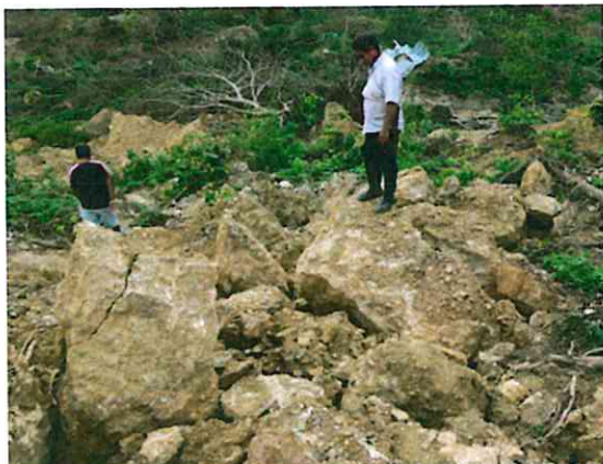
Fotos 8 y 9. En ambas imágenes se aprecia bloques de margas, que tienen formas angulosas. La primera vista es de la parte superior y la segunda de la parte media del deslizamiento.
