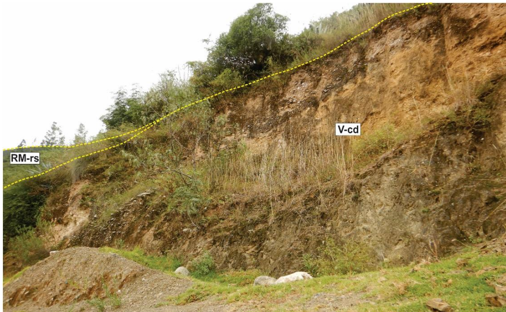
Figura 10. Depósitos coluvio-deluviales cubiertos por pastos y arbustos característicos de la zona, ubicados en la margen izquierda del jirón Comercio.
