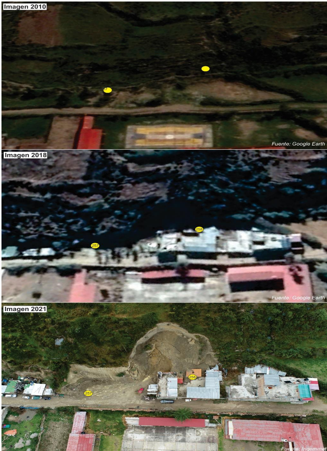
Figura 19. Comparación de imágenes satelitales de los años 2010, 2018 (Google Earth) y la imagen 2021 (tomada con el dron el 24 de mayo de 2021), post deslizamiento en el Jirón Comercio.
