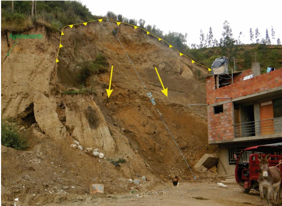
Figura 13. Vista frontal del deslizamiento, donde observa una longitud de escarpa de 36.5 m, un salto principal de aproximadamente 3.5 m y una distancia entre la escarpa y pie de 21 m.
