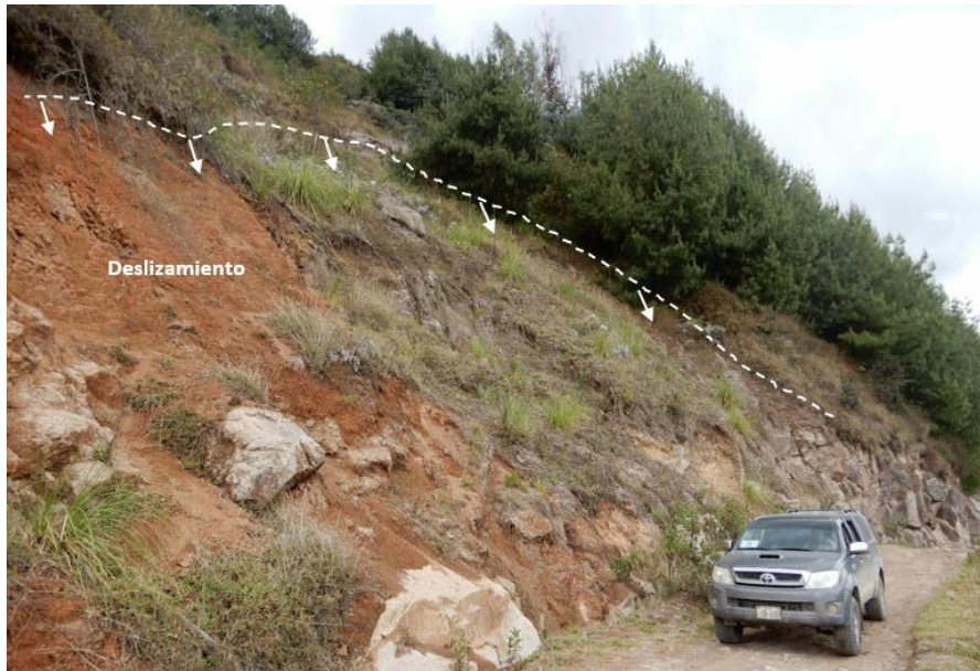
Figura 6. Vista del sector con coordenadas 720735 E / 9248045 N, donde se ha desplazado suelos coluviales y rocas volcánicas muy meteorizadas en transición a suelo.
