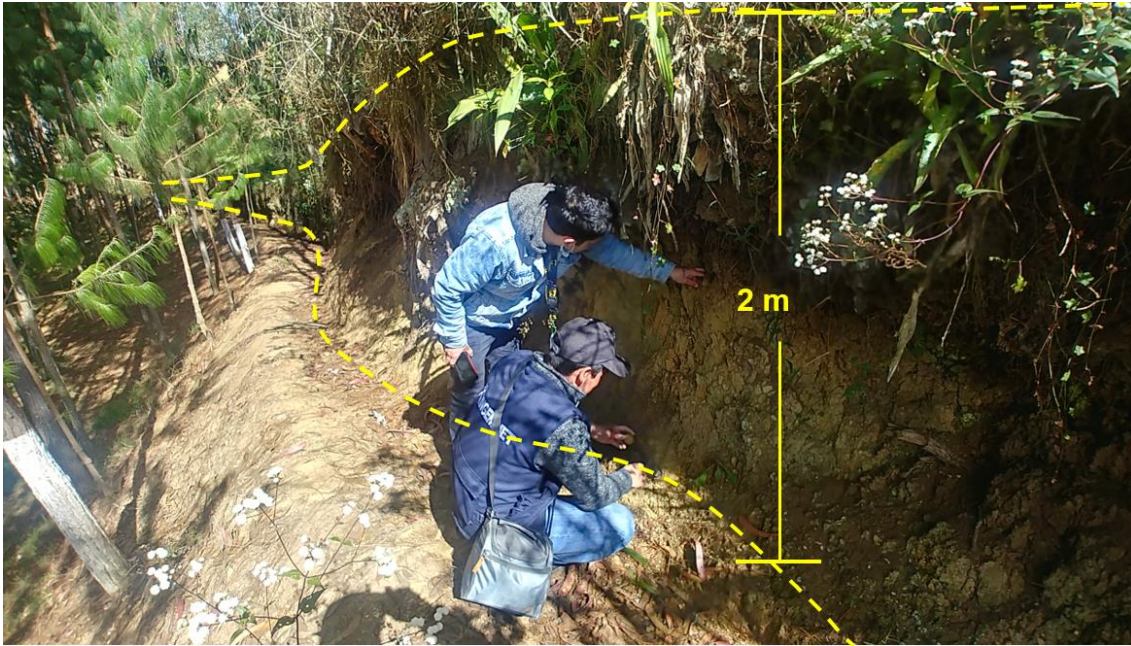
Figura 8. Escarpe de deslizamiento antiguo ubicado dentro del Camposanto Nuevo mundo al noroeste del sector Los Olivos
