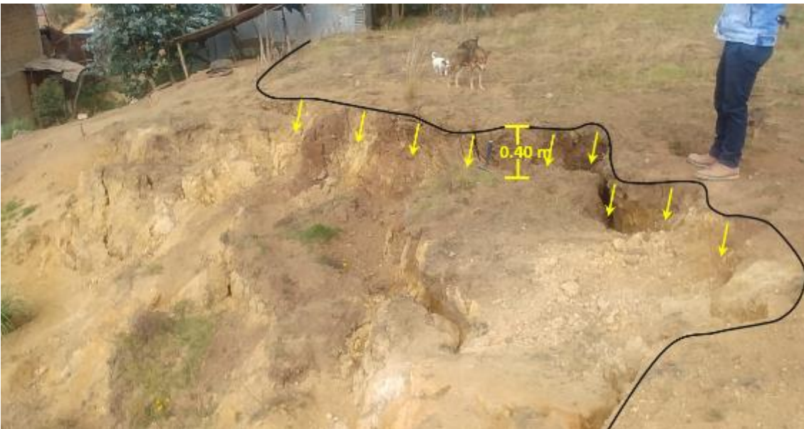
Figura 11. Escarpe secundario con un desplazamiento vertical de 0.40 m.
