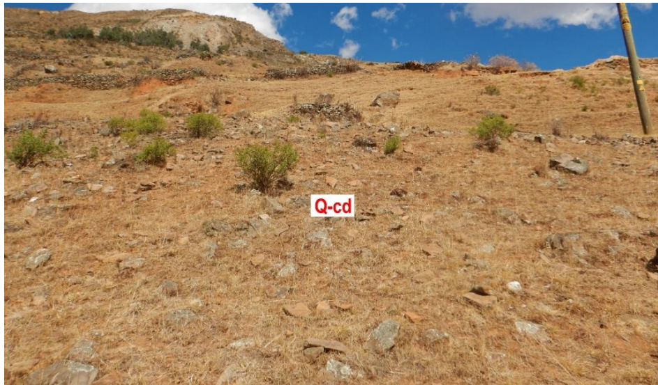
Figura 6. Depósitos coluvio-deluvial formado por fragmentos de roca angulosos de tamaño variable envueltos en una matriz limoarcilloso.
