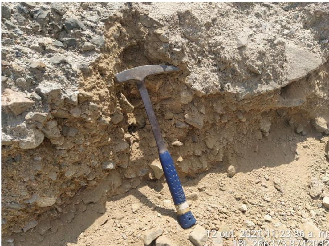
**Figura 9.** Depósitos proluviales, conformado por gravas heterométricas de hasta 10 cm, envueltos en una matriz arcillosa.
