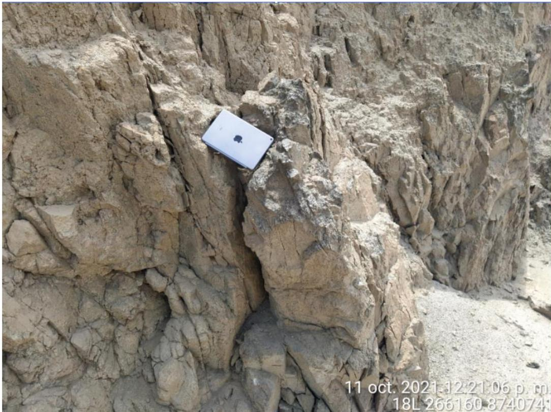
**Figura 8.** Muestra el alto grado de meteorización, de las rocas ígneas del Batolito de la Costa, que genera suelos residuales.
