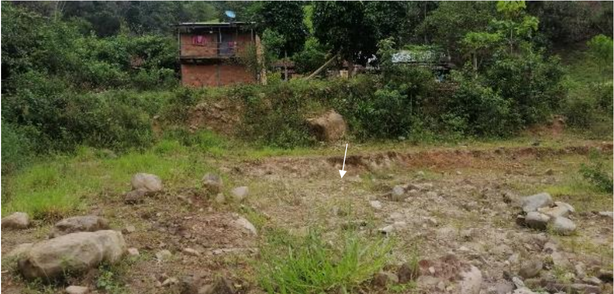
Figura 19. Depósitos aluviales antiguos matriz soportados aflorantes en el terreno donde se pretende construir el hospital del centro poblado Nuevo San Miguel.
