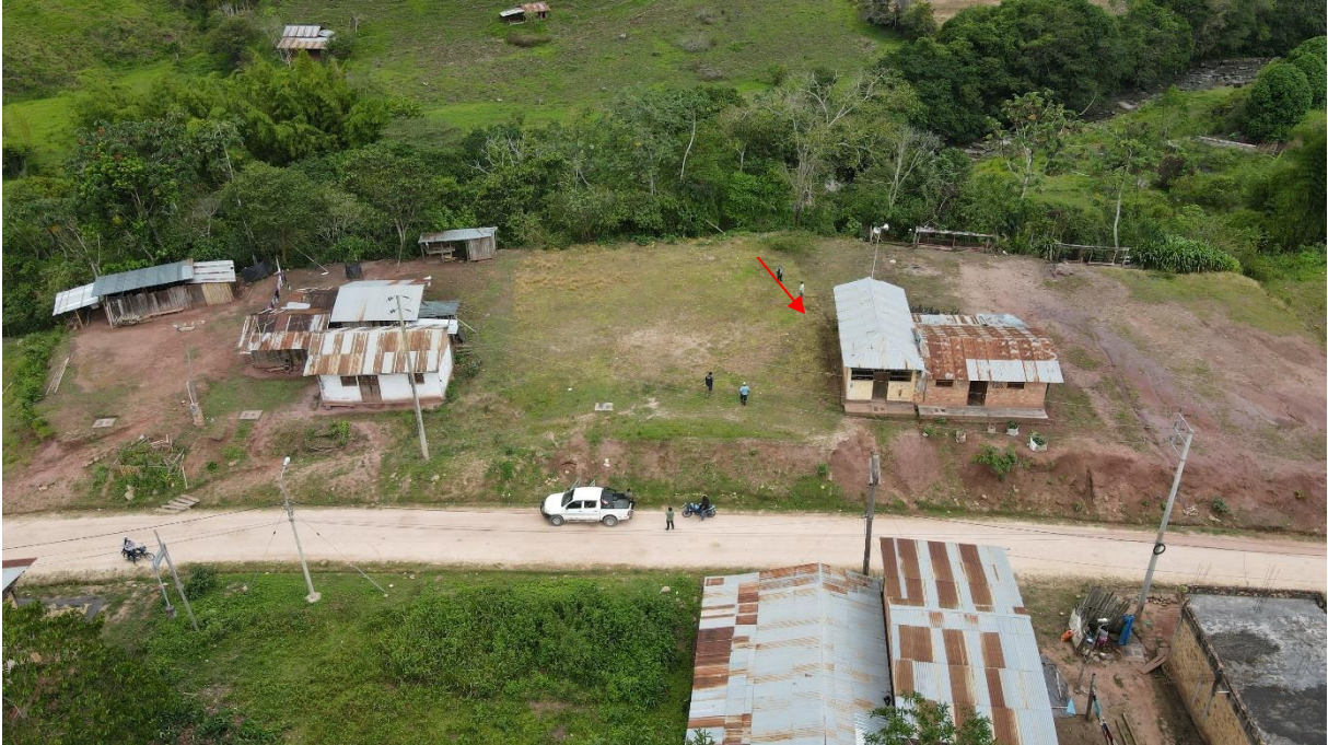
Figura 13. Explanación realizada sobre lodolitas y areniscas de la Formación Yahuarango, donde se proyecta la construcción de la comisaría local.
