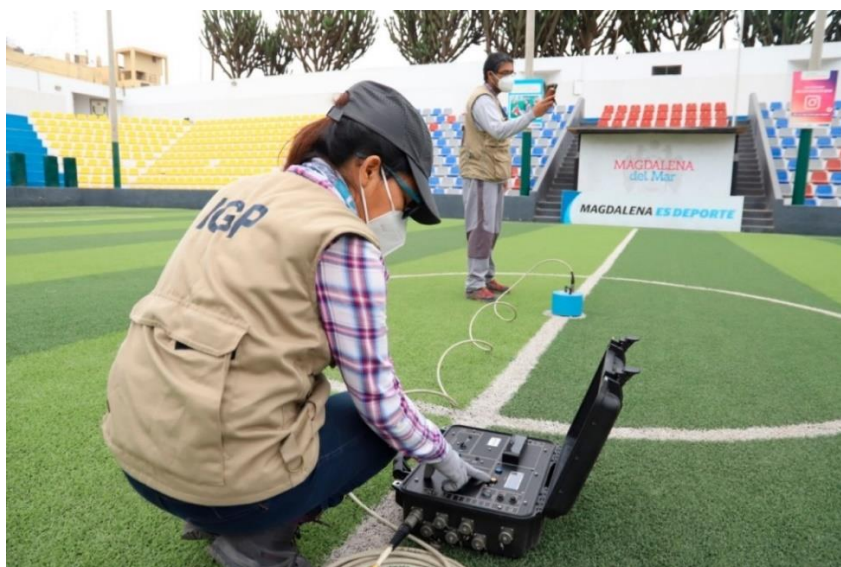
Figura 26. Equipo sísmico utilizado para el registro de vibraciones ambientales: sensor Lennartz (2N) y registradores CityShark II.
