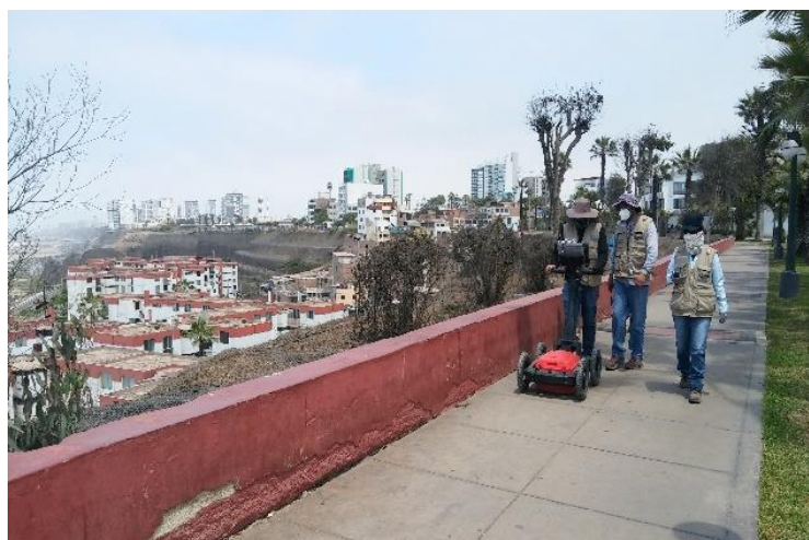
Figura 22. Disposición del georadar utilizando la antena de 350 MHz.
