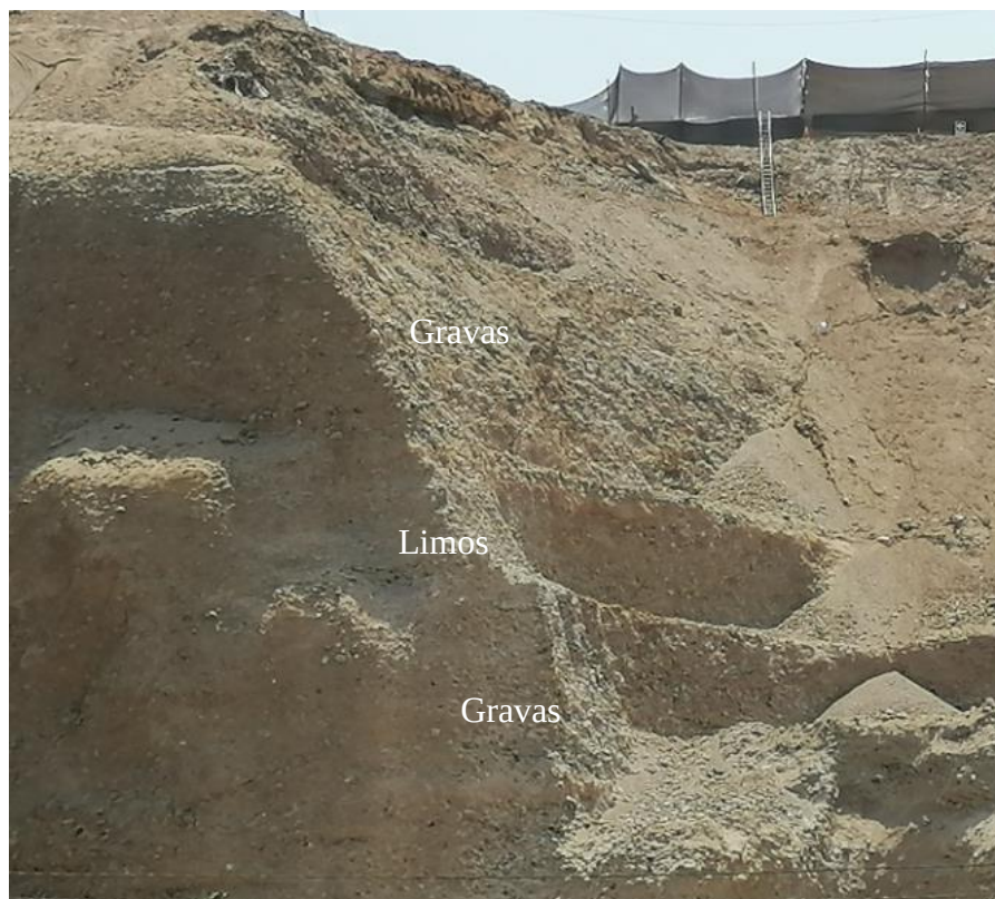
Figura 4: a) Vista de la estratigrafía de los ACV en el distrito de Magdalena del Mar (espalda coliseo Aldo Chamocho). Obsérvese la presencia de depósitos aluviales, gravas sub redondeadas con intercalaciones de lentes de limos.
