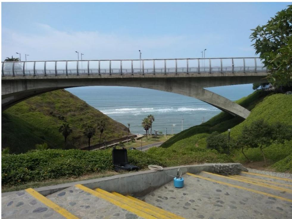
*Figura 26. Equipo sísmico utilizado para el registro de vibraciones ambientales: sensor Lennartz (2N) y registradores CityShark II.*
