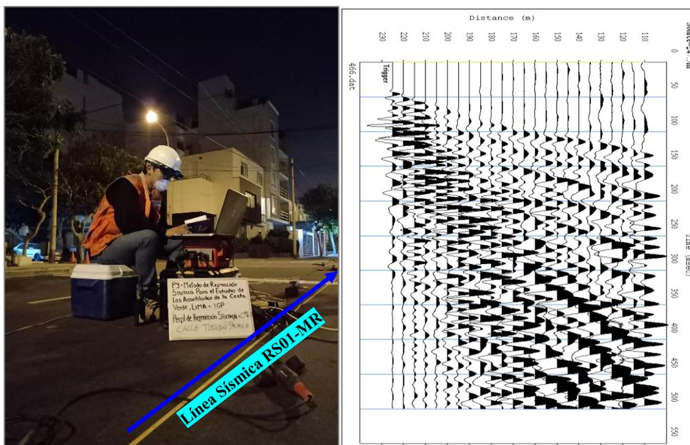
Figura 7. Disposición del equipo de adquisición de datos con la técnica de refracción sísmica (RS01-MR, calle Toribio Pacheco) y registro sísmico obtenido.
