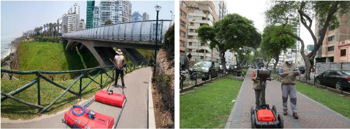
*Figura 22. Disposición del georadar utilizando las antenas de 100 MHz y 350 MHz.*
