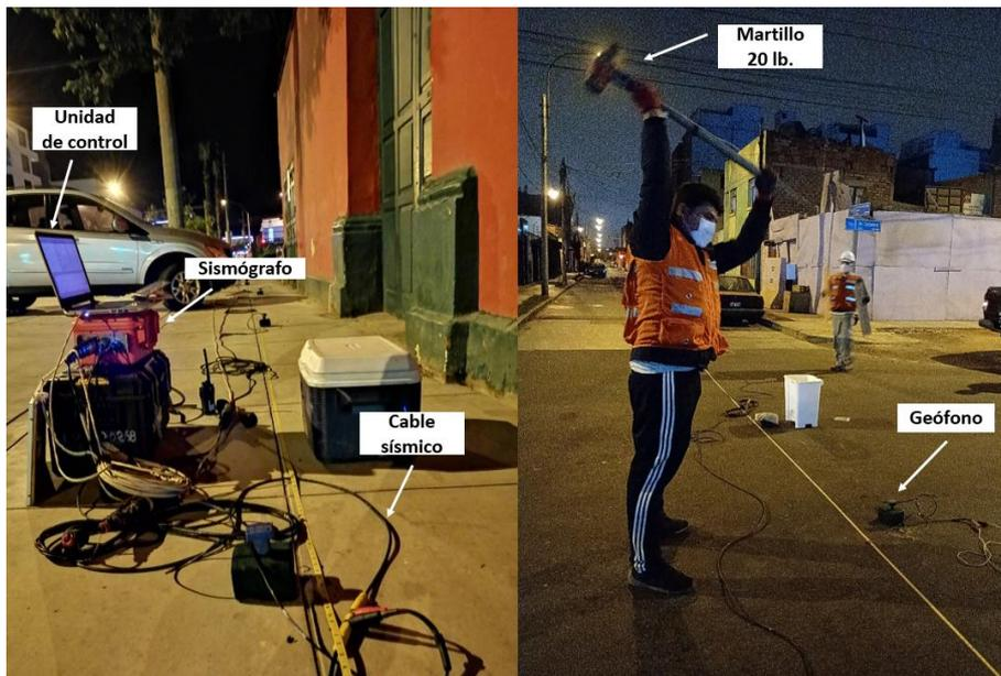
Figura 5. Equipos utilizados en la adquisición de datos de RS.
