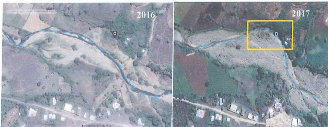
Figura 14.- Meandro aparentemente formado durante el año 2017 en el margen derecho de la quebrada Suyo. En este lugar se desarrolla procesos de erosión fluvial (rectángulo amarillo), principalmente en la ladera ubicada en la parte baja de canal de irrigación.
