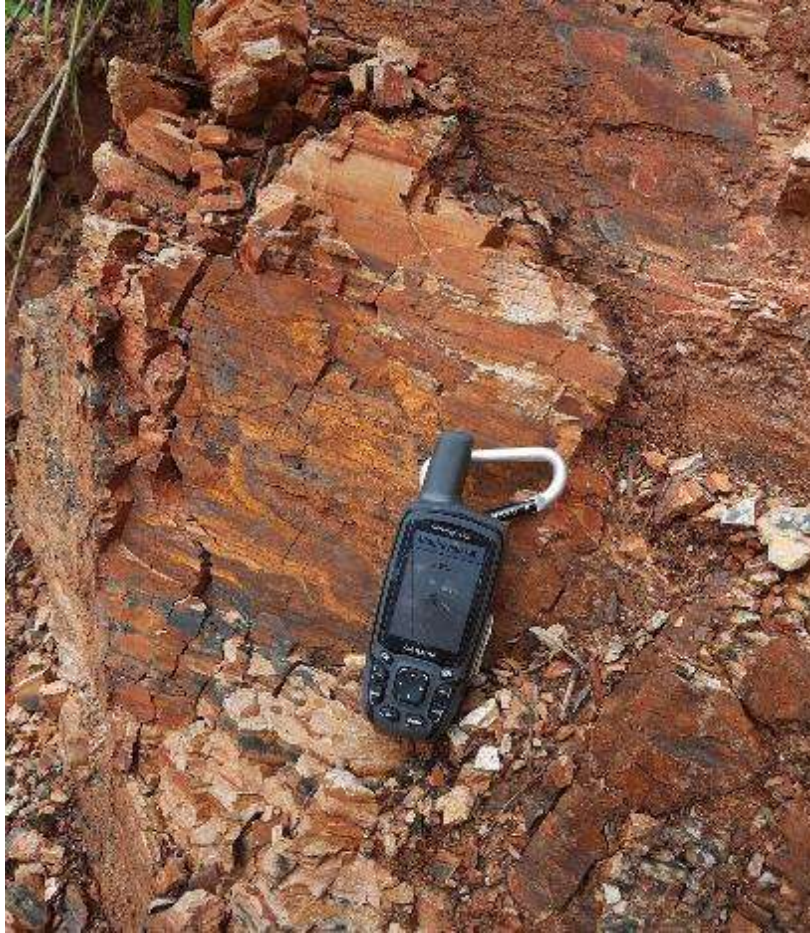
Fotografía 3: Pizarras fuertemente fracturada y patinas de Fe por oxidación. Ubicada en las coordenadas UTM WGS84: 655232 Este; 8585684 Norte
