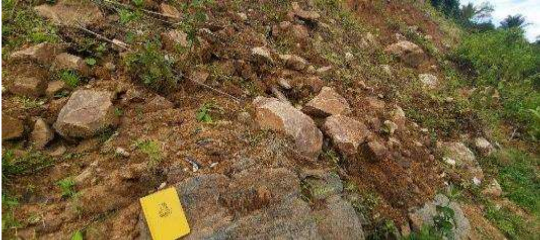
Fotografía 5: Vista de una mezcla de fragmentos heterogéneos subredondeados envueltos en una matriz limo-arenosa, relleno del flanco izquierdo del río Periaventura.
