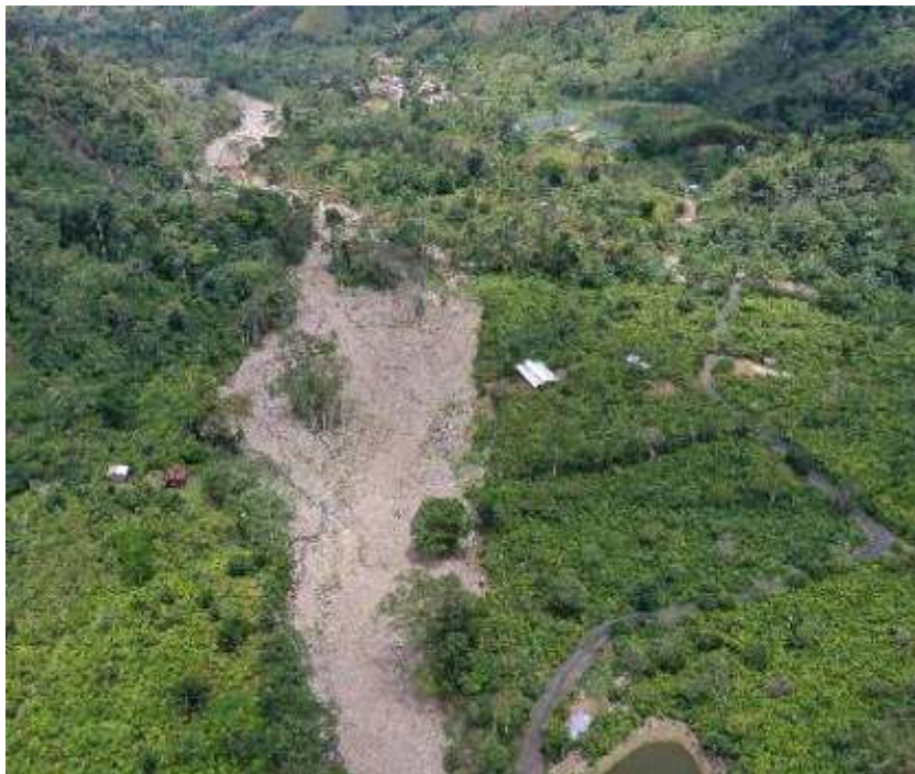
Fotografía 10: Vista aérea del sector de Nogalpampa Alta y el nuevo cauce del río Otari (después del flujo de detritos de abril de 2021). Se observan a lo largo del recorrido la presencia de zonas susceptibles a inundación frente a crecidas excepcionales, a ambos flancos del río Otari.
