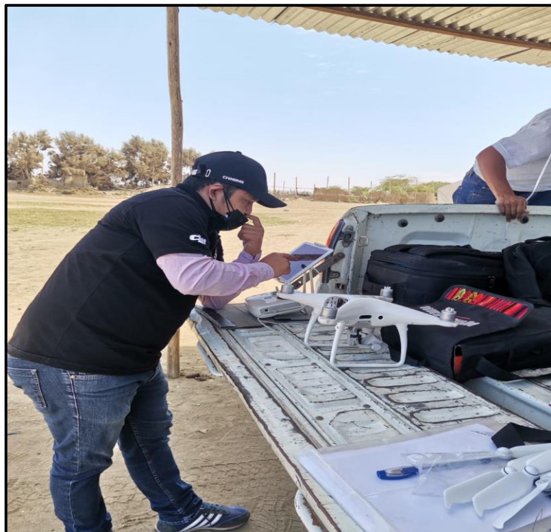
REALIZANDO LEVANTAMIENTO TOPOGRAFICO CON DRONE
