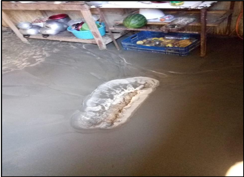
VOLCÁN DE ARENA COMO EVIDENCIA DE PROCESOS DE LICUACIÓN DE SUELOS EN LA ZONA URBANA DE LA ISLA- VIENDAS DE LA ISLA SAN LORENZO.
