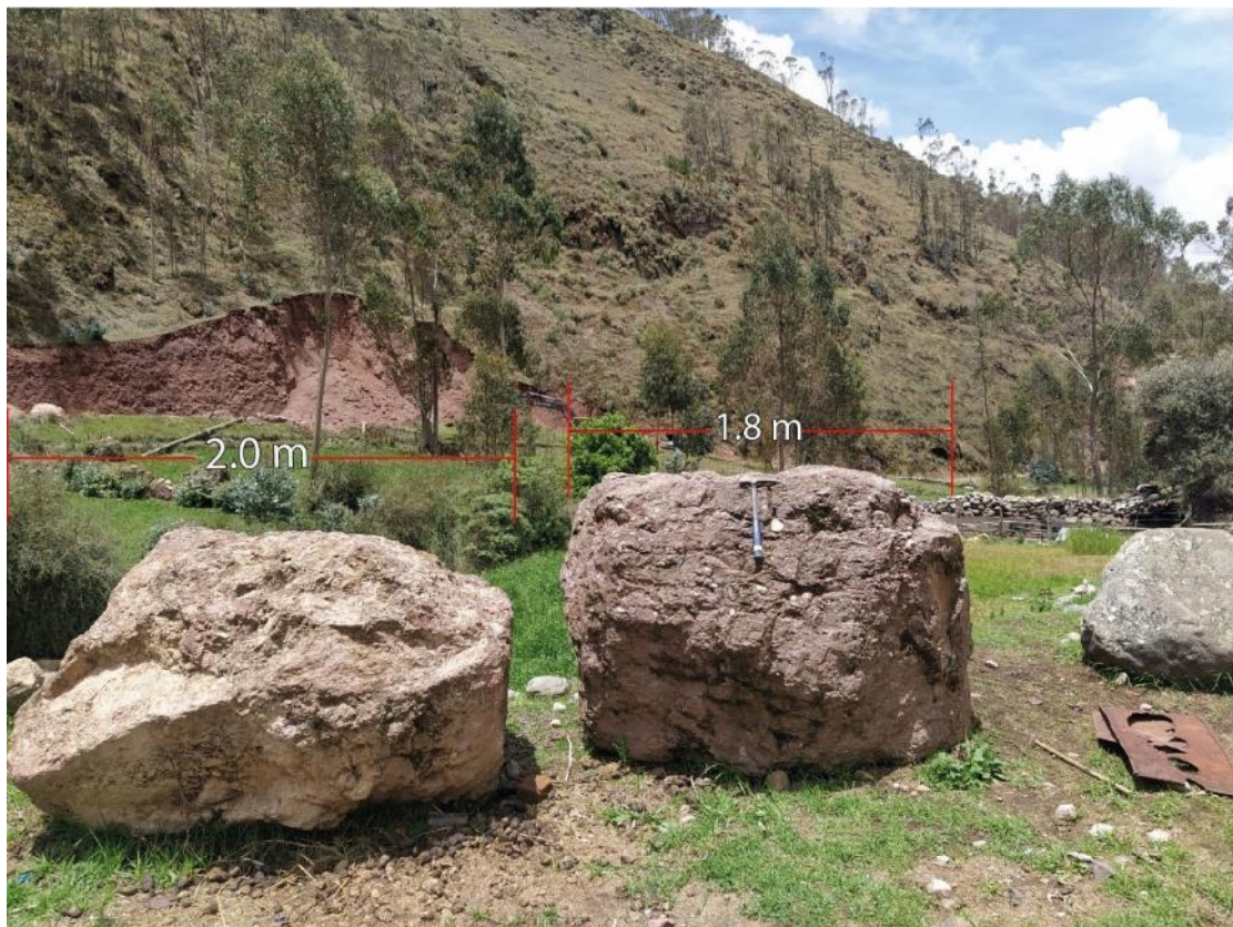
Figura 15. Bloques de roca conglomerados de hasta 2 m, ubicados en el patio externo de la I.E. 30470, por caída.
