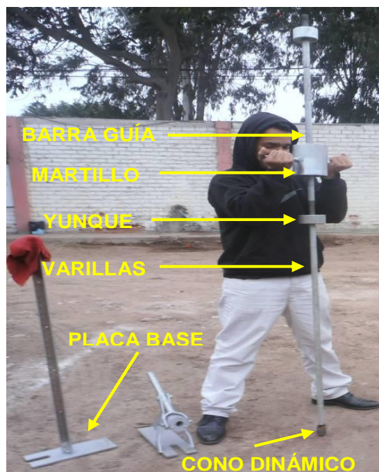
Figura 02: Equipo y accesorios que conforman el DPL
