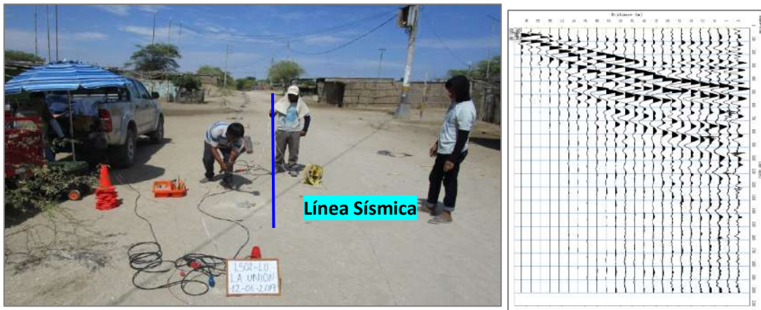
Figura 7. Disposición del equipo de adquisición de registro sísmico.
