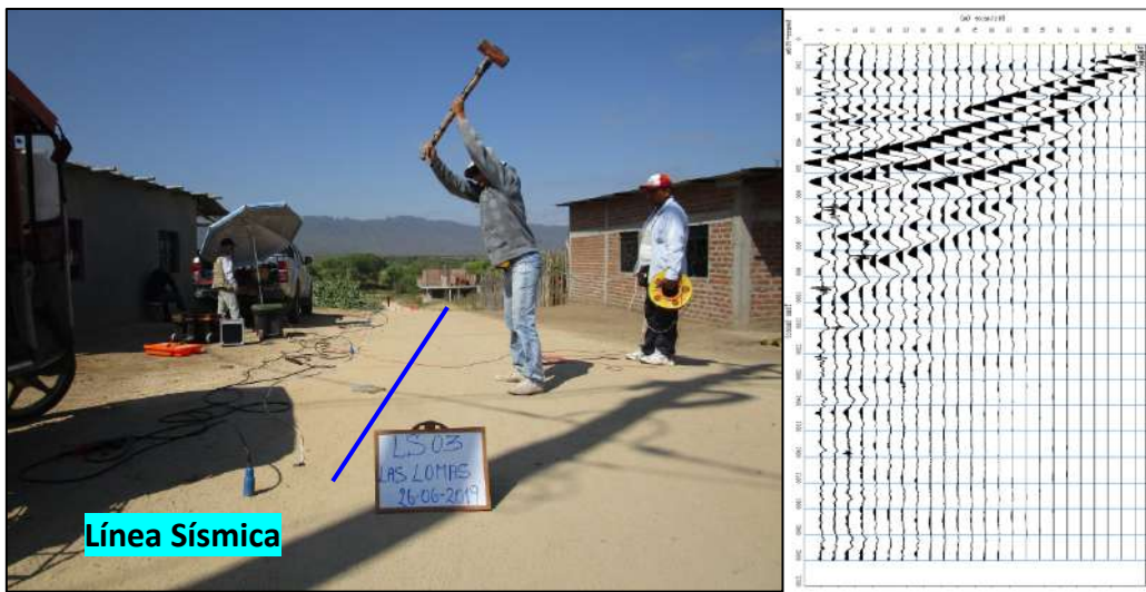
Figura 7. Disposición del equipo para la adquisición del registro sísmico.
