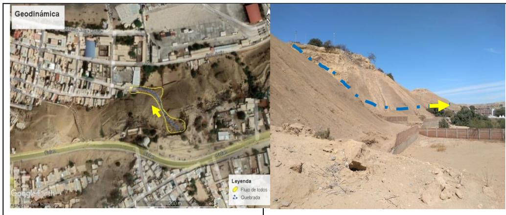
Figura 12.- Imagen panorámica (Izquierda) de la zona donde se activan los flujos de lodos, que afectan la seguridad física de la zona. En la imagen de la derecha, se muestra el perfil de la quebrada. La flecha e color amarillo indica la dirección del flujo
