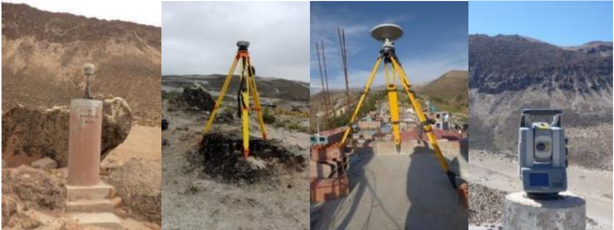
Figura 3.11. Equipos para mediciones GNSS (GPS) y EDM en el volcán Ticsani, empleados durante el año 2018.
