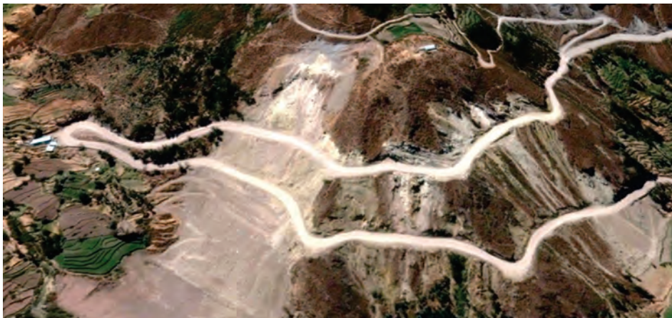
Figura 7.28 Carretera de acceso entre Cotahuasi y Chuquibamba (Km 8+100) afectada y susceptible a derrumbes por corte de talud para su construcción. Imagen Google Earth.
