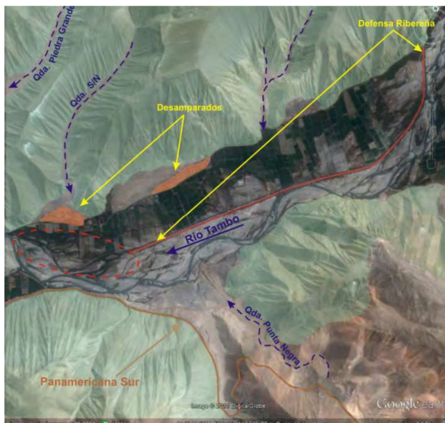
Figura 7.60 Imagen satelital del Google Earth del sector de Desamparados. Se muestra la defensa ribereña, el círculo de color rojo de línea entrecortada es el área afectada por la erosión fluvial. Los sectores con líneas de color azul entrecortadas son las quebradas que pueden generar flujos de detritos.
