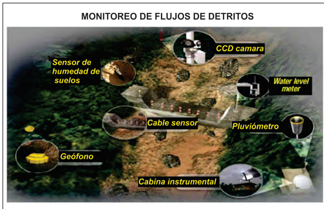
Figura 8.27 Sensores utilizados para el monitoreo de flujos de detritos (fotografía tomada de Soil and Water Conservation Bureau SWCB-Taiwan por Vilchez, 2010).
