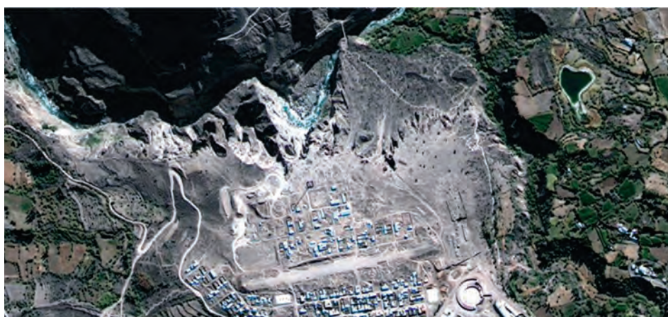
Figura 7.27 Población de la Urbanización Pampa de Aymaña III Etapa, ubicada en la margen izquierda de río Cotahuasi. Además, se observa la ribera del río, susceptible a pequeños derrumbes, erosión en cárcava y fluvial. Imagen Google Earth.
