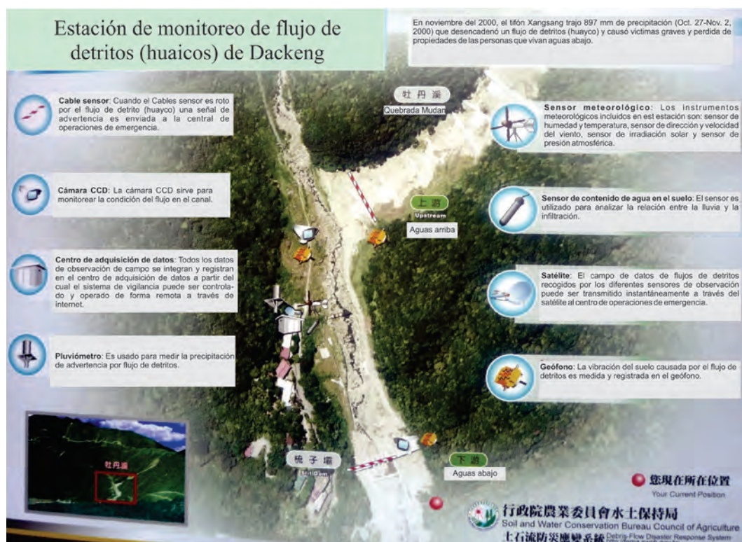
Figura 8.28 Estación de monitoreo de flujo de detritos (fotografía tomada de Soil and Water Conservation Bureau SWCB-Taiwan por Vilchez, 2010).
