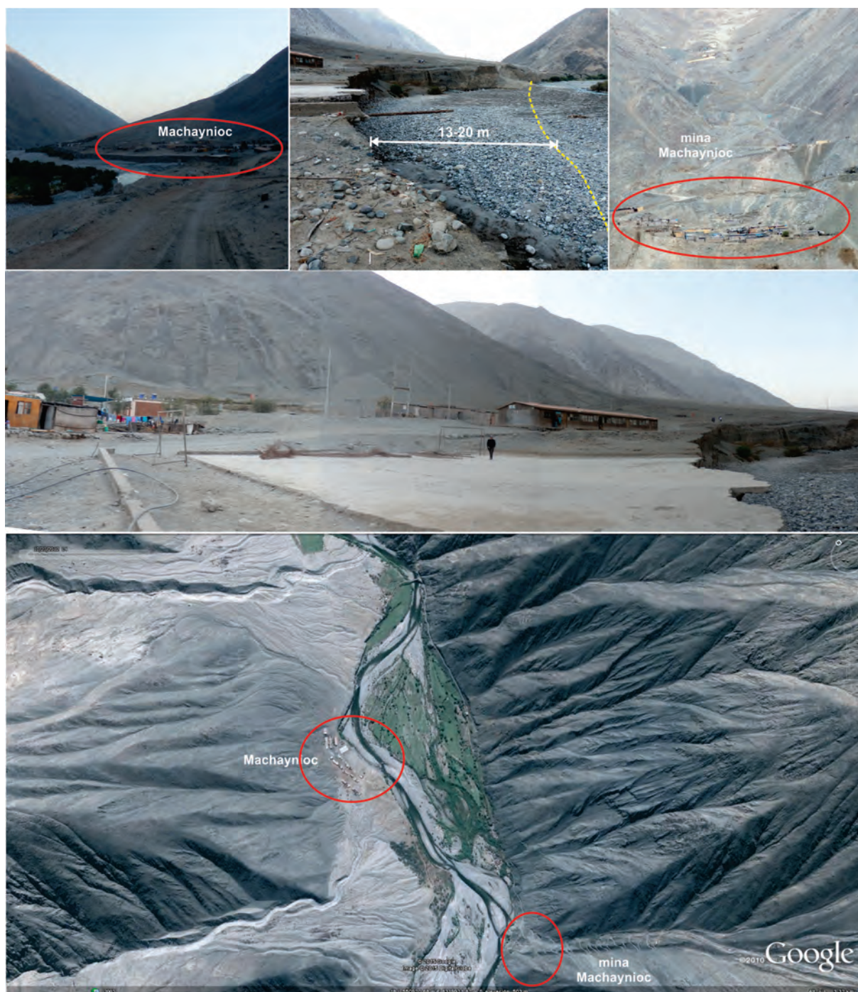
Figura 7.1 Vistas del sector Machaynioc afectado por erosión fluvial en la margen derecha del río Machaynioc. El poblado se encuentra sobre depósitos de flujos antiguos como se muestra en la imagen del Google Earth.
