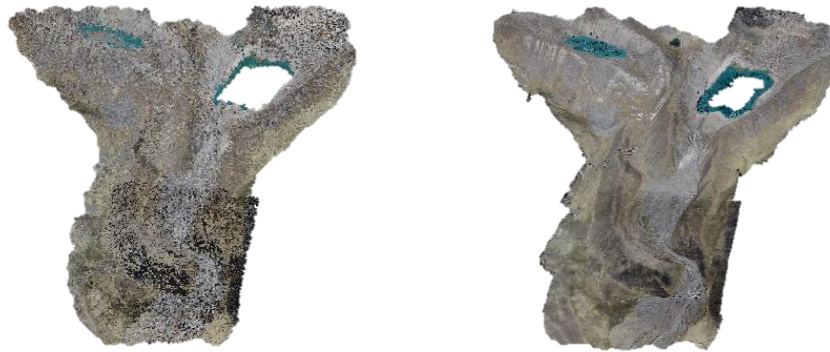
Ilustración 3. Nube de puntos dispersa (izquierda) y nube de puntos densa (derecha), software Agisoft metashape
