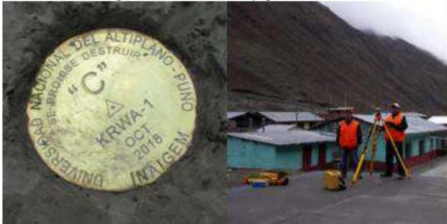
Figura 3. Puntos de control topográfico monumentados en inmediaciones de las lagunas Sorapata y Vizcachani.
