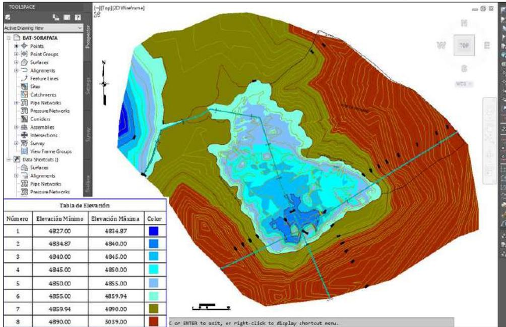
Figura 5. Vista del resultado en la unión de los datos topográficos y batimétricos para la laguna Vizcachani, es posibles apreciar en colores los diferentes niveles de profundidad en la laguna.
