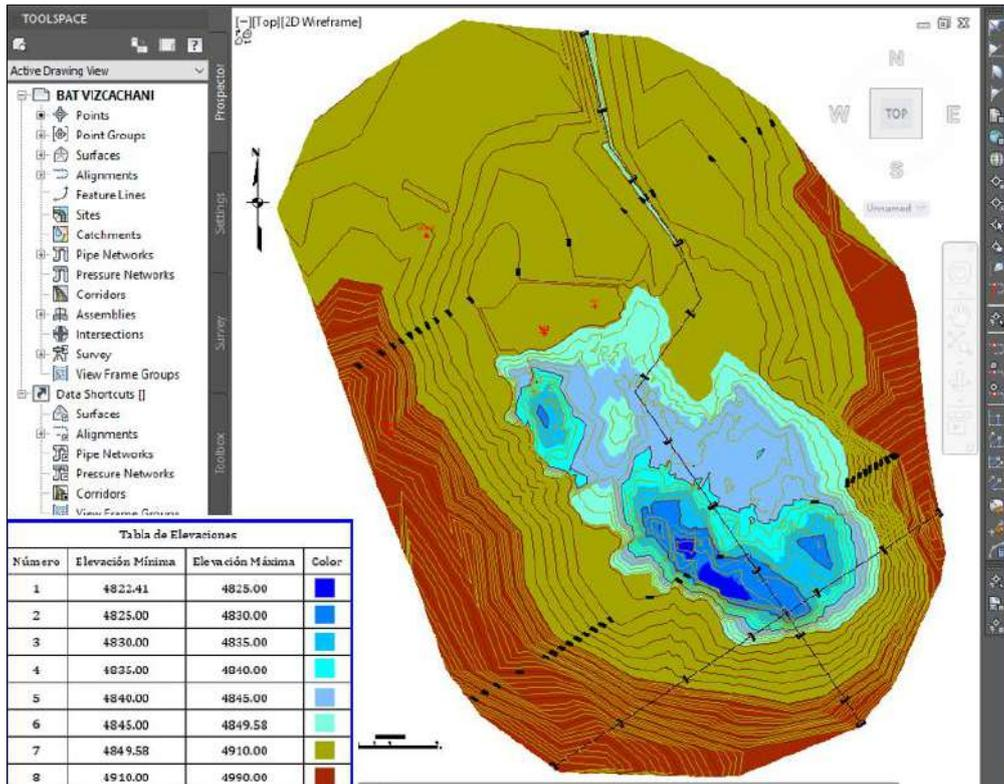
Figura 6. El cálculo de la curva área – volumen para la laguna Sorapata.
