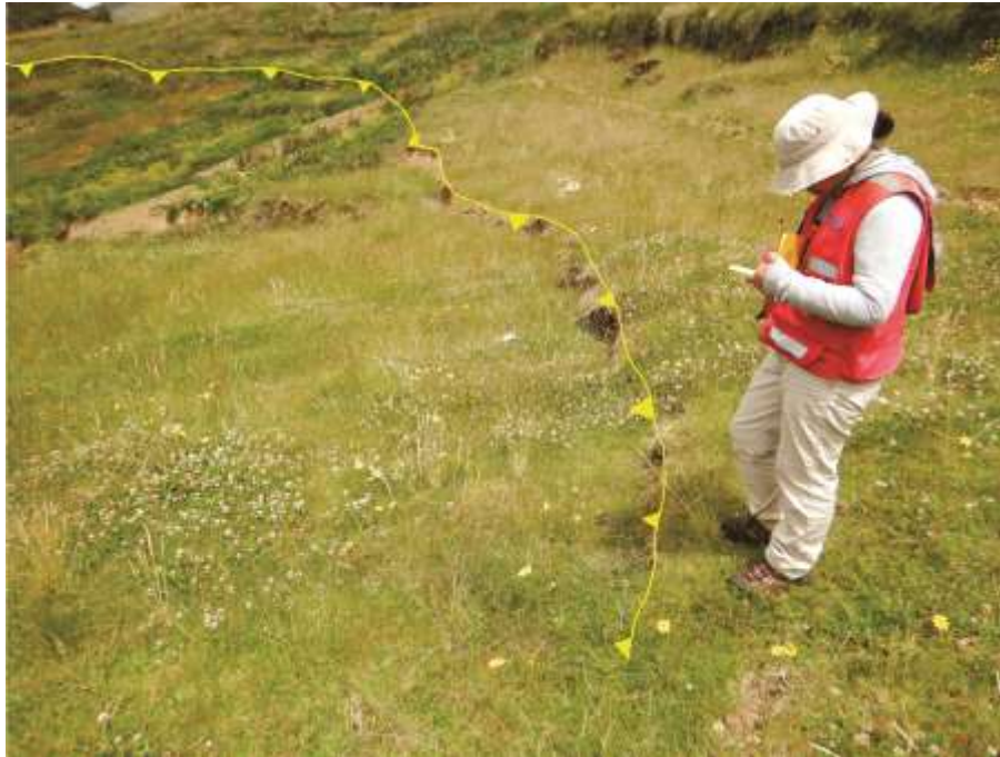
Figura 11. Escarpa de deslizamiento de forma semicircular
