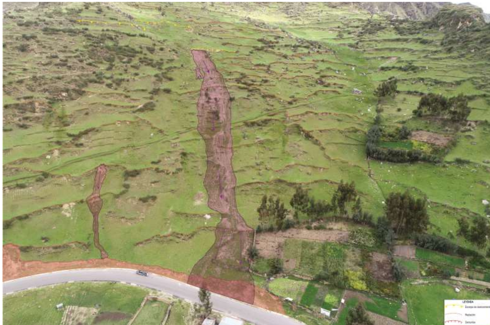
Figura 6. Cartografía de Flujo de lodo en la zona de estudio (polígono morado), deslizamientos que se encuentran en la parte alta (líneas amarillas) y reptación (Líneas anaranjadas) originados por las fuertes lluvias del mes de febrero. Imagen tomada con un vehículo aéreo no tripulado (dron).
