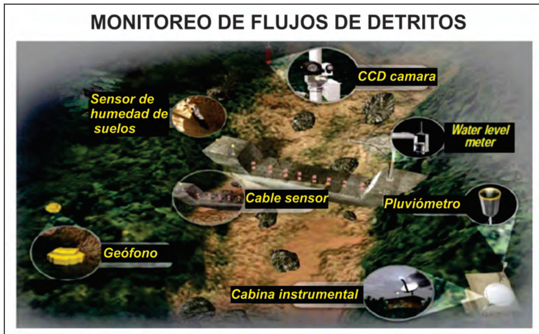
Figura 8.27 Sensores utilizados para el monitoreo de flujos de detritos (fotografía tomada en el Soil and Water Conservation Bureau SWCB-Taiwan; Vilchez, 2010).
