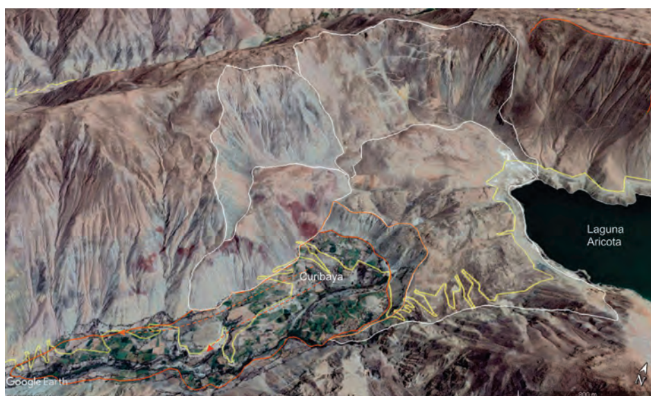
Figura 6.16 Movimiento complejo (deslizamiento-flujo de detritos) en el sector Curibaya (línea de color naranja) como reactivación de los mega deslizamientos antiguos que represaron el río Curibaya dando origen a la laguna Aricota, distrito de Curibaya.
