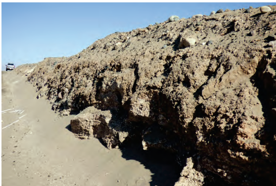
Fotografía 4.9 Perfil litológico de una vertiente aluvio torrencial. Se observa lo desordenado o caótico de sus componentes que revela el origen aluviónico del depósito.
