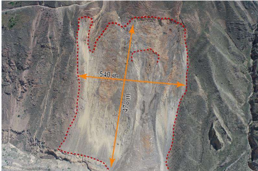
Figura 20. Características visuales y dimensiones del proceso de derrumbe que afectó el sector Retamayoc de la Comunidad Campesina San Francisco de Huacho.
