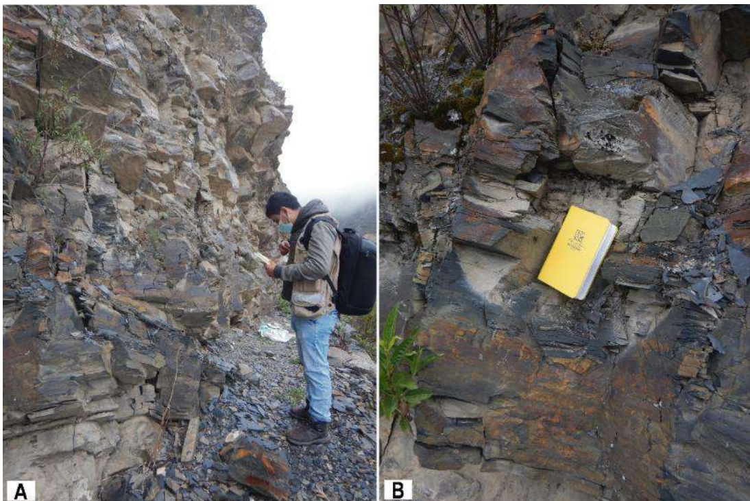
Figura 7. A. Sustrato rocoso conformado por una secuencia de limoarcillitas grises a negras, esquistosas, intercaladas en estratos delgados de areniscas grises, de la Formación Chicama, miembro Churín. B. Detalle de las limoarcillitas grises las cuales se encuentran muy fracturadas, con espaciamentos próximas entre sí (0.06 – 0.20 m), aberturas abiertas (1,0-5,0 mm) y además se presentan altamente meteorizado.
