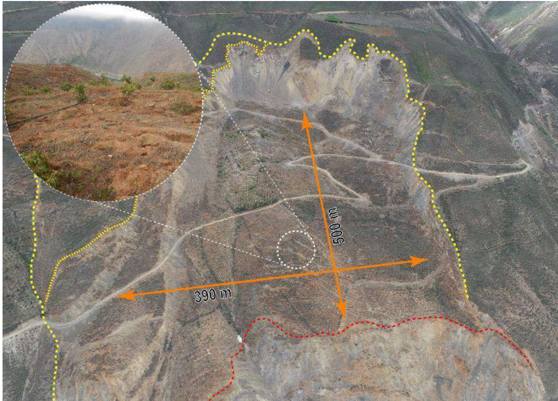
Figura 16. Características visuales y dimensiones del proceso de deslizamiento que afectó el sector Retamayoc de la Comunidad Campesina San Francisco de Huacho.
