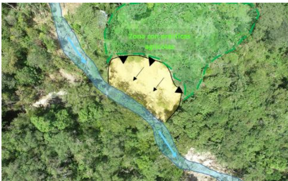
Figura 11. Zona con cultivos agrícolas (riego por gravedad), saturan los suelos produciendo deslizamientos en dirección al cauce de la quebrada, para luego, con dirección hacia el cauce de la quebrada y posteriormente originar el flujo de detritos.
