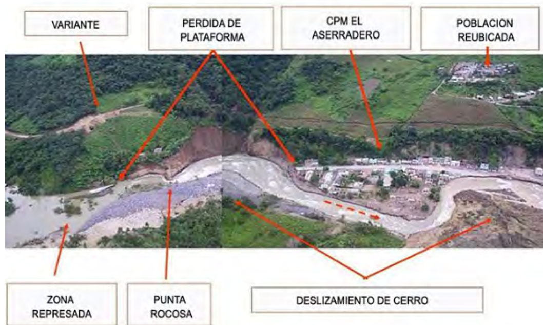
Foto 10.19.- Centro Poblado Aserradero después del desastre de marzo de 1998. La zona fue afectada por deslizamientos, inundación y erosión fluvial.
