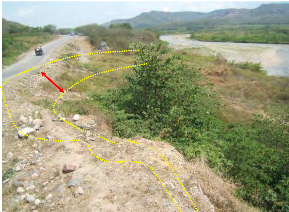
Foto 10.24.- Deslizamiento rotacional elongado en la margen izquierda del río Utcubamba, cerca del puerto de Motupe, kilómetro 241.
