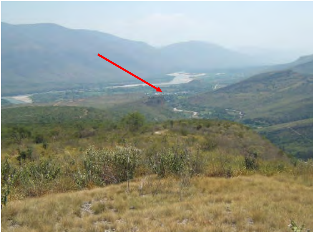
Foto 10.18.- Viviendas de Tagtago asentadas en antiguo depósito de flujo de detritos provenientes de las quebradas Limones, Mojoncho y Llangugo.
