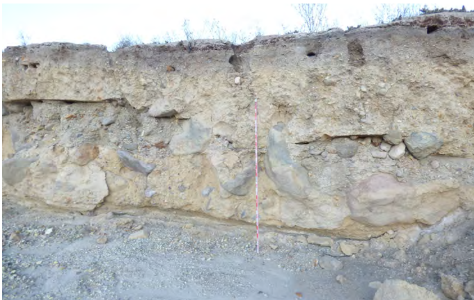
Fotografía 3.5 Vista de la margen izquierda de un tributario de la quebrada Azufral socavado en la Pampa Cura, donde es posible ver tres niveles de flujos de detritos conformados por material grueso de tipo gravas subangulosas a subredondeadas, englobado en matriz fina; así como material gravo limo-arcilloso; los depósitos se presentan muy compactados y duros. Toda la secuencia aparece cubierta por un depósito de caída de cenizas piroclásticas.
