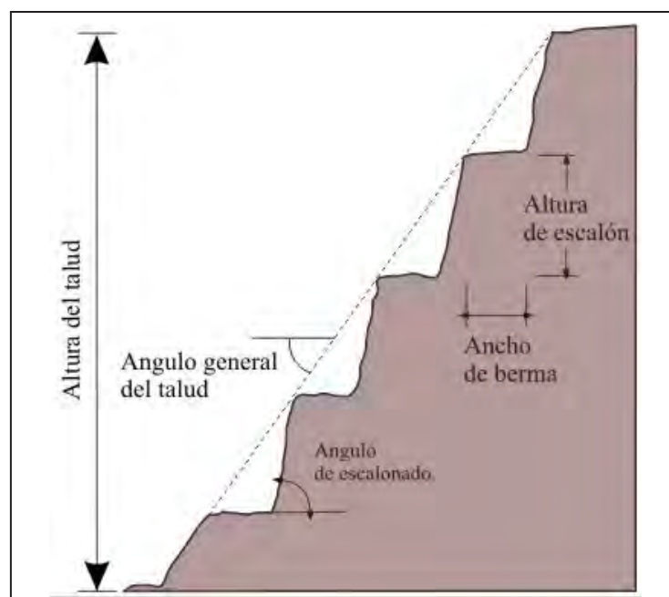
Figura 8.3 Esquema de un talud con bermas intermedias (Instituto Geológico Minero y Metalúrgico, 2000).
