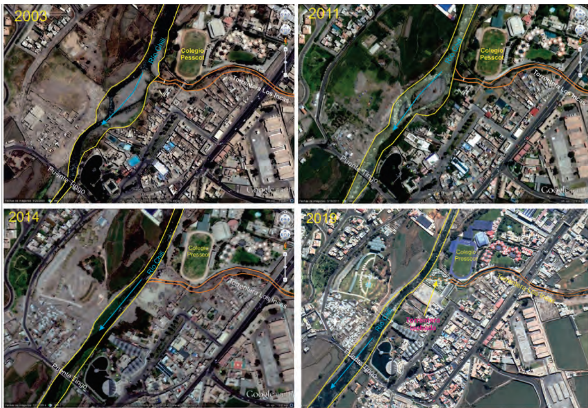
Figura 6.17 Secuencia de imágenes donde se observa cómo se ha impactado y alterado el cauce del río Chili y de la quebrada Los Incas tributaria por su margen izquierda; esta última se ha cubierto o techado el tramo final de la quebrada.
