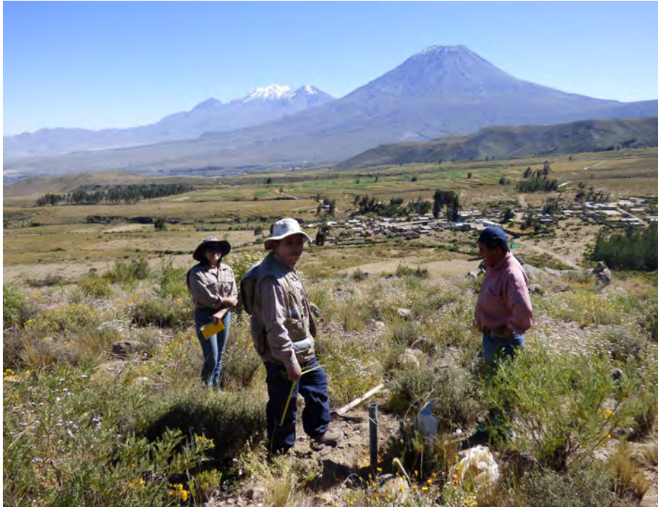
Fotografía 4.8 Ensayo de infiltración EI-12 ( K=0.30 m/día) realizado sobre rocas vulcano-clásticas, avalancha de escombros.
