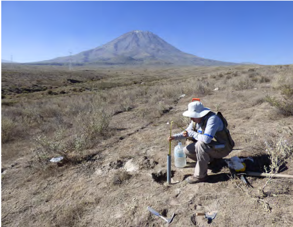
Fotografía 4.7 Ensayo de infiltración EI-08 ( K=0.34 m/día) realizado sobre flujos piroclásticos y cenizas.
