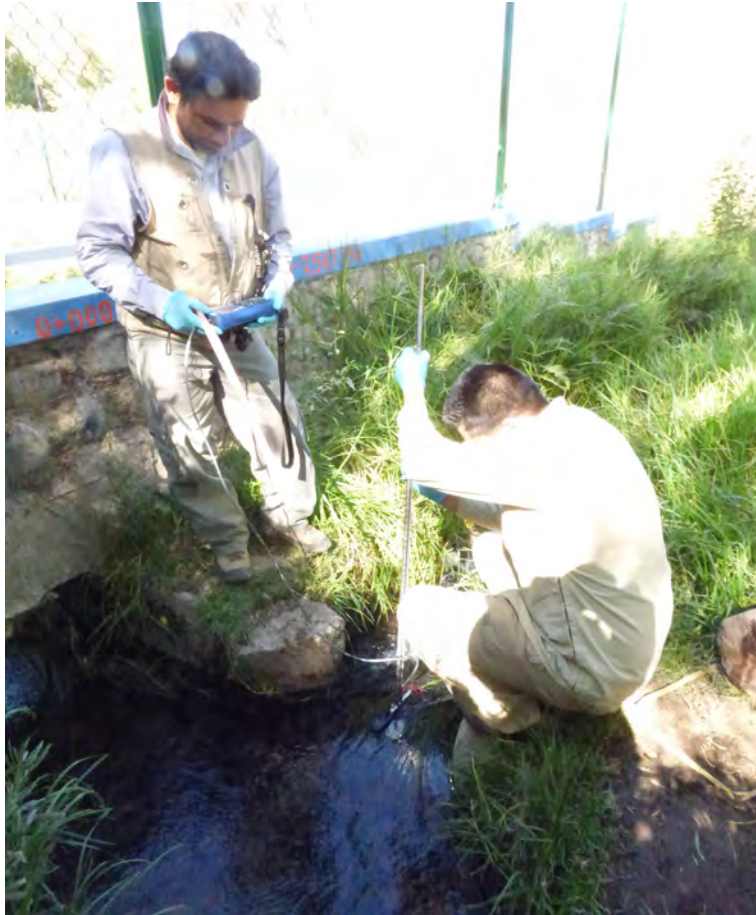
Fotografía 4.2 Aforo del manantial Ojo del Milagro 1, usando correntómetro, Q = 114.0 l/s.
