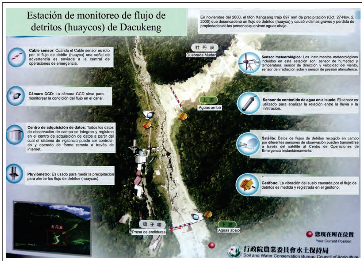
Figura 8.34 Esquema de los equipos que deben conformar una estación de monitoreo de flujo de detritos y/o lodo.
