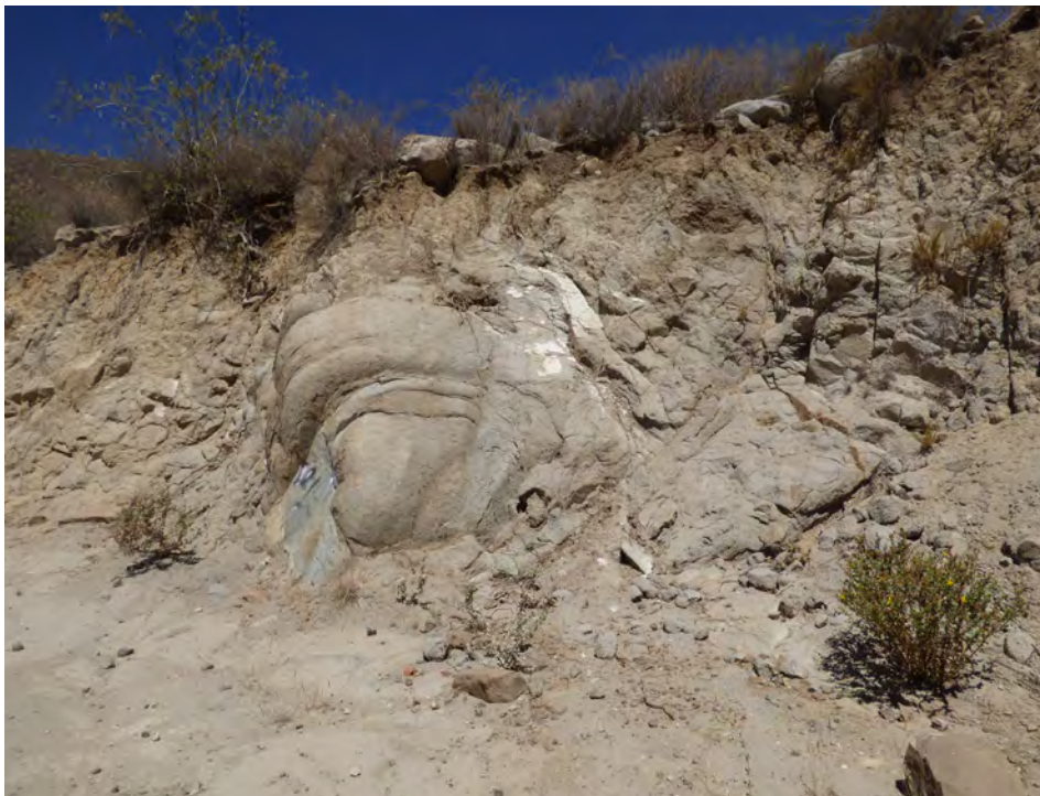
Fotografía 3.13 Dioritas de la Súper Unidad Yarabamba afectadas por disyución esferoidal y disgregación granular que manifiesta el alto grado de alteración de la roca, sector cerros Pajonal y Malpaso, distrito de Mollebaya.
