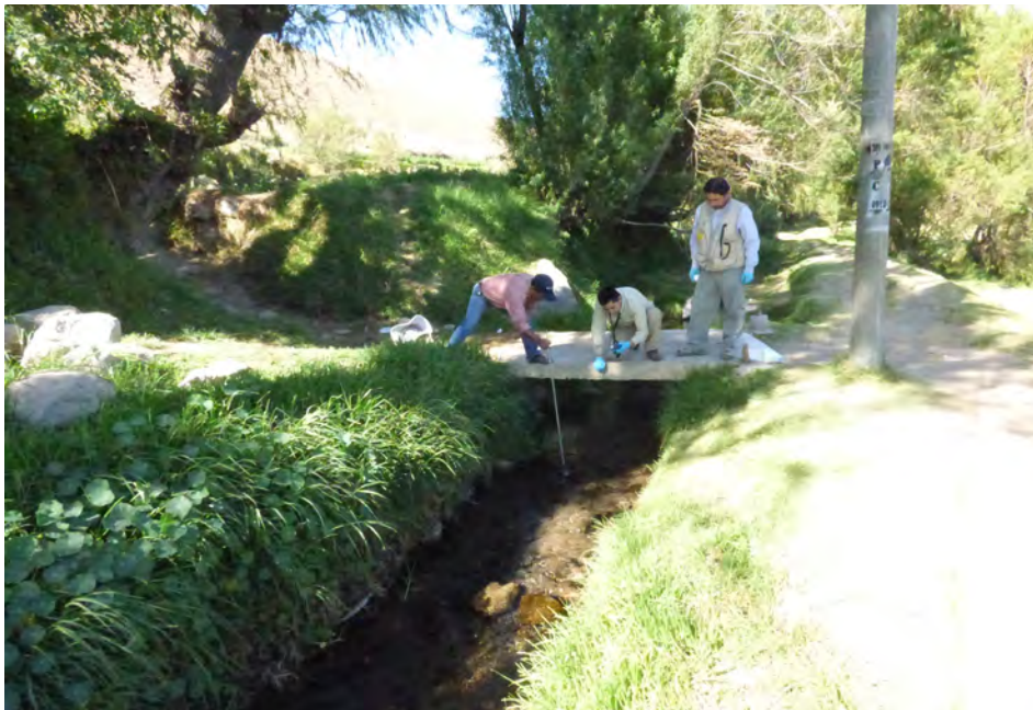
Fotografía 4.3 Aforo del manantial Ojo del Milagro 2, usando correntómetro, Q = 98.0 l/s.
