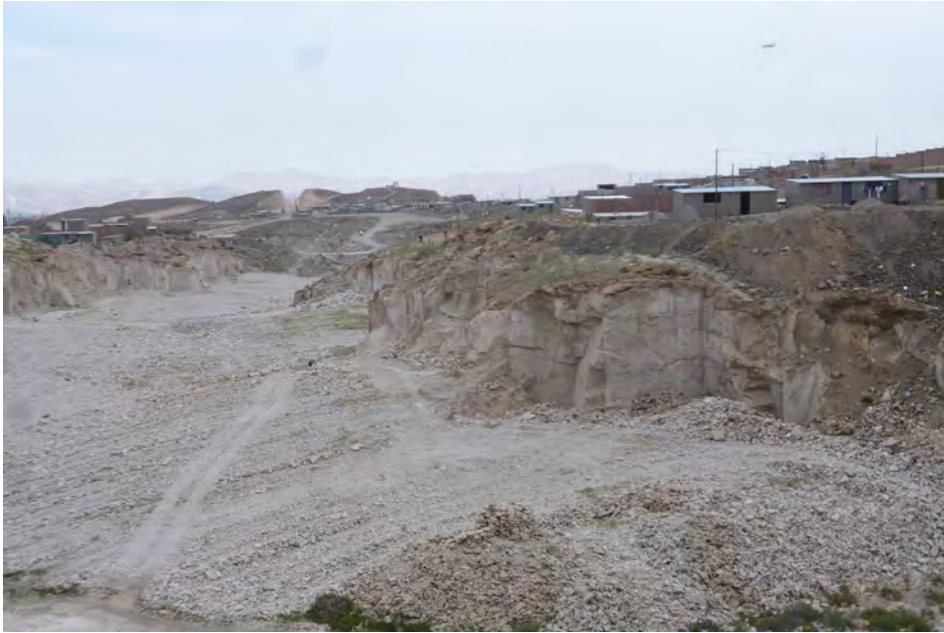
Fotografía 5.29 Vista con dirección hacia el suroeste donde se ve puede observar el cauce de una quebrada seca, la cual ha sido cubierta completamente por el desmorte producto de la extracción de bloques de sillar; distrito Cerro Colorado.
