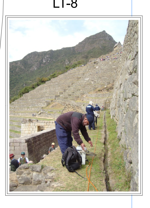
Transversal a una falla mapeada en superficie Anomalia Vertical \rho_a < 1000 \text{ Ohm-m} Puntos: 50 a 60 m
