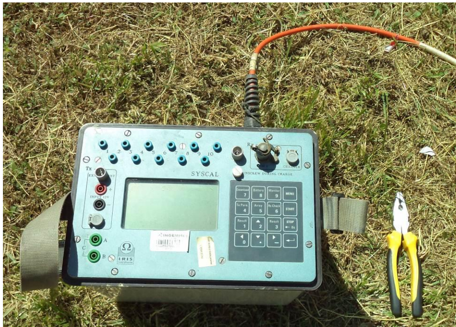
Foto N° 6: Equipo Resistivimetro Syscal Pro 48 empleado para los registros de los datos de campo en las diez (10) líneas de tomografía eléctrica en la ciudadela inca.
