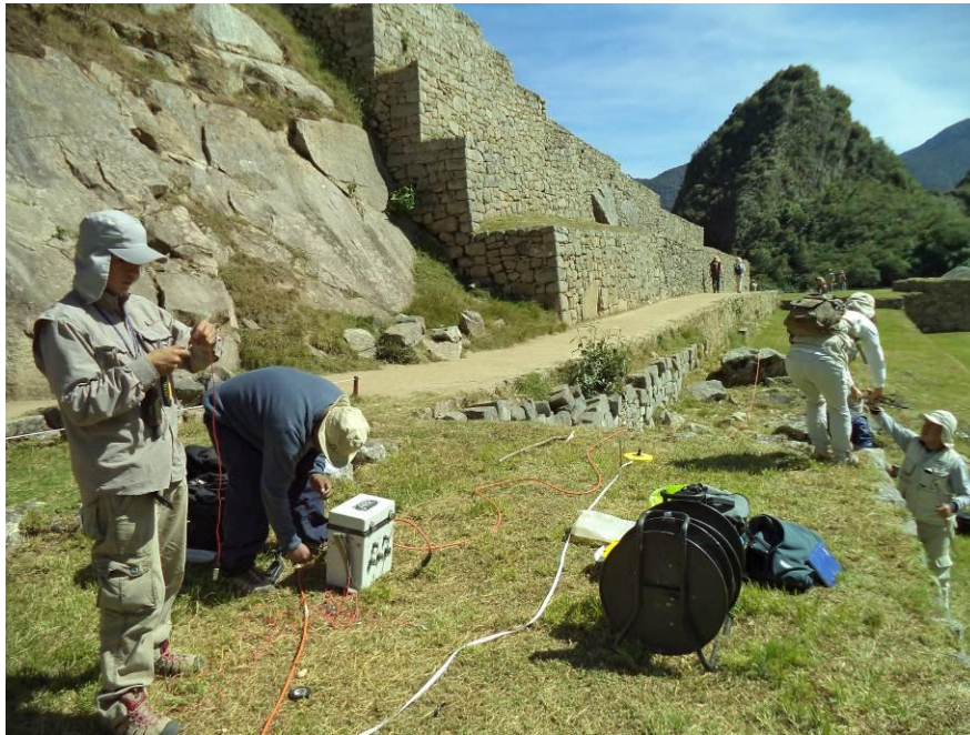
Foto N°1: Equipo de Resistividad Syscal Pro 48 digital nótese el levantamiento de campo de la línea LT-1, borde de la plaza principal.
