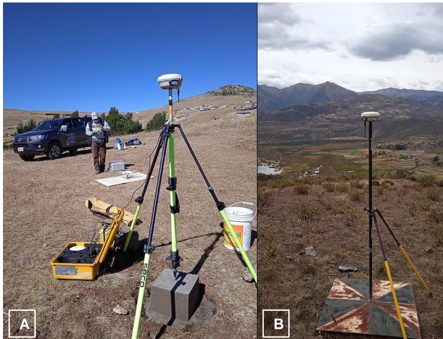
Figura 6. Instalación de Equipos para Levantamiento GNSS RTK. Los valores de corrección se envían directamente por radio desde la estación base (A) al receptor móvil (B). De esta manera, con este último se puede registrar continuamente su posición relativa al punto de referencia con una precisión por debajo del decímetro.
