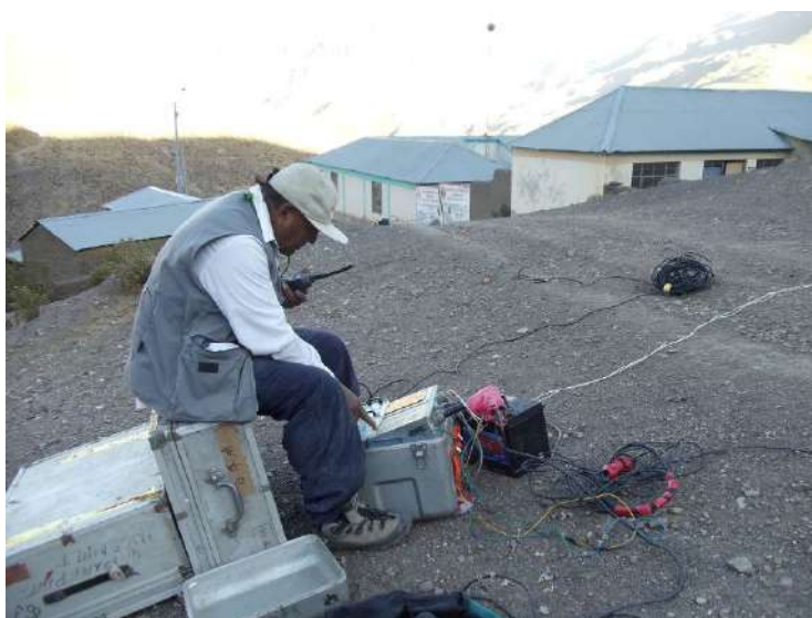
Foto 3.4: Registro de lecturas en la línea más larga LS-01 transversal a la quebrada principal del área de estudio.
