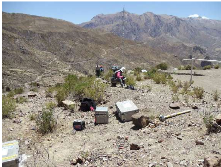
Foto 3.2: Equipo de Refracción Sísmica en la Línea LS-01 en el tramo 1 cota más alta de la línea de tendido.
