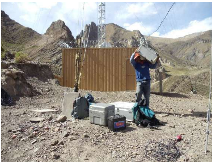
Foto 3.3: Equipo de Refracción Sísmica OYO – McSEIS 170 – trasladándose a otro tramo de la Línea elástica LS-01 hacia la parte de la plaza principal antigua de Tassa.
